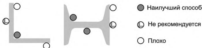
Рисунок 44.R21 — Расположение кабелей внутри элементов металлических конструкций
