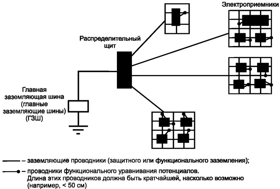
Рисунок 44.R14 — Пример радиального соединения нескольких сетчатых систем
