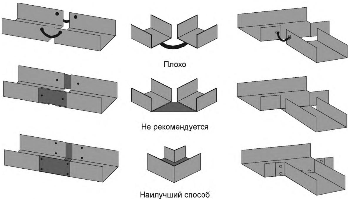
Рисунок 44.R20 — Непрерывность системы, состоящей из металлических компонентов
