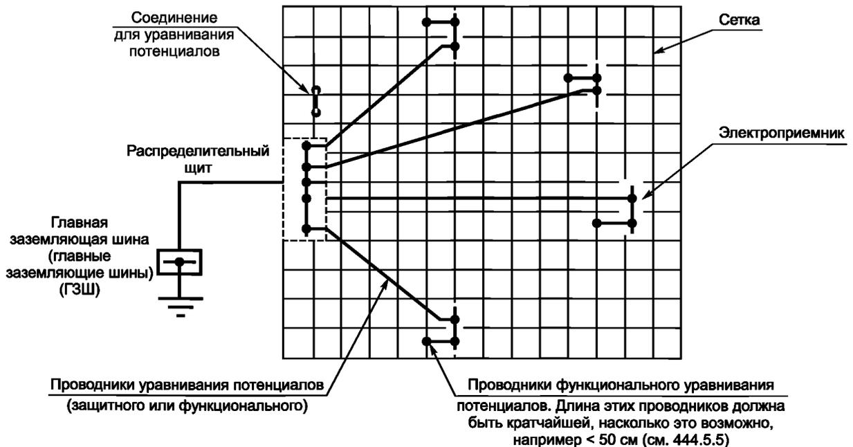
Рисунок 44.R15 — Пример совмещенной сетчато-радиальной системы уравнивания потенциалов
