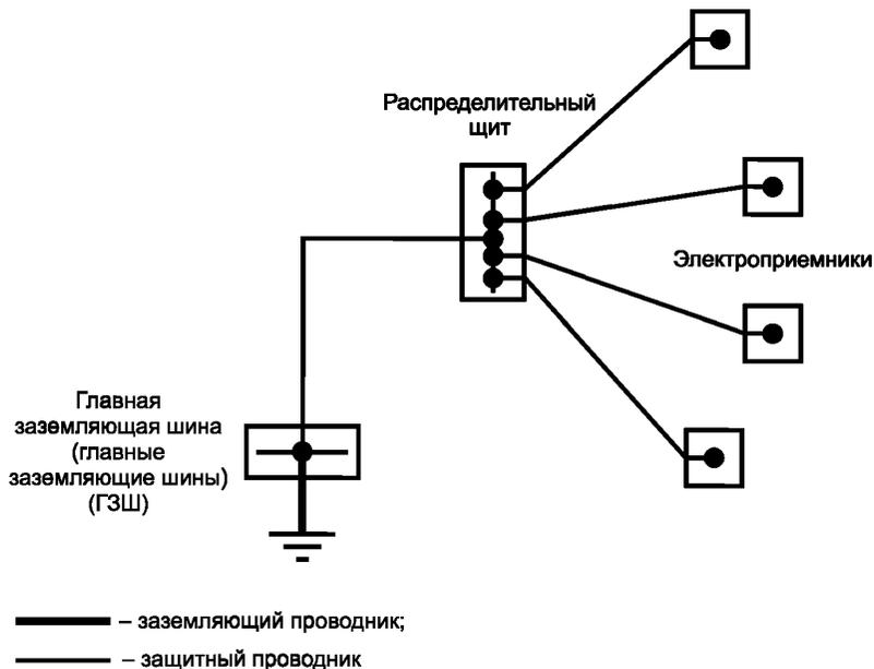
Рисунок 44.R13 — Примеры радиального соединения защитных проводников
