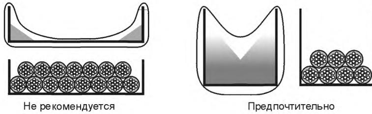
Рисунок 44.R 19 — Прокладка кабелей в металлических кабельных лотках
