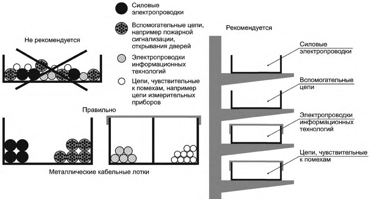
Рисунок 44.R18 — Разделение кабелей в электропроводах
