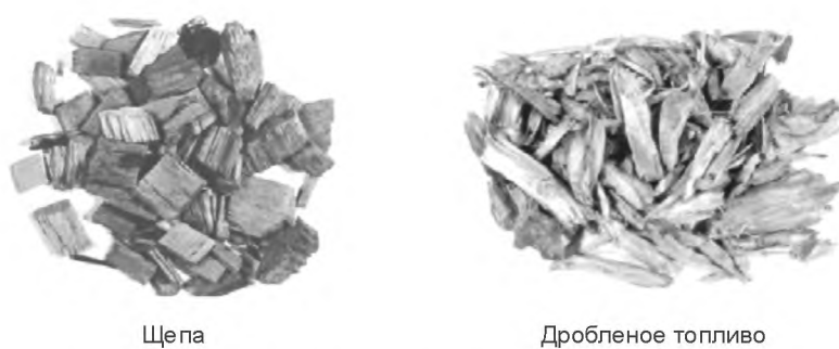
Рисунок А.2 — Различие между щепой и дробленой древесиной
