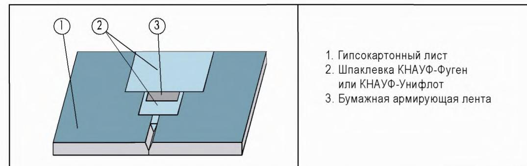
Рис. 3. Заделка стыков, образованных торцевыми кромками гипсокартонных листов
