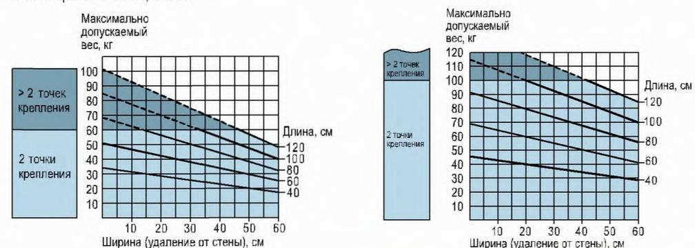
Рис. 5. Подбор максимально допустимой нагрузки
