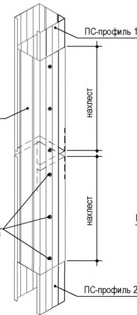
2 ПС-профиля, соединенных встык и объединенных дополнительным ПН-профилем
