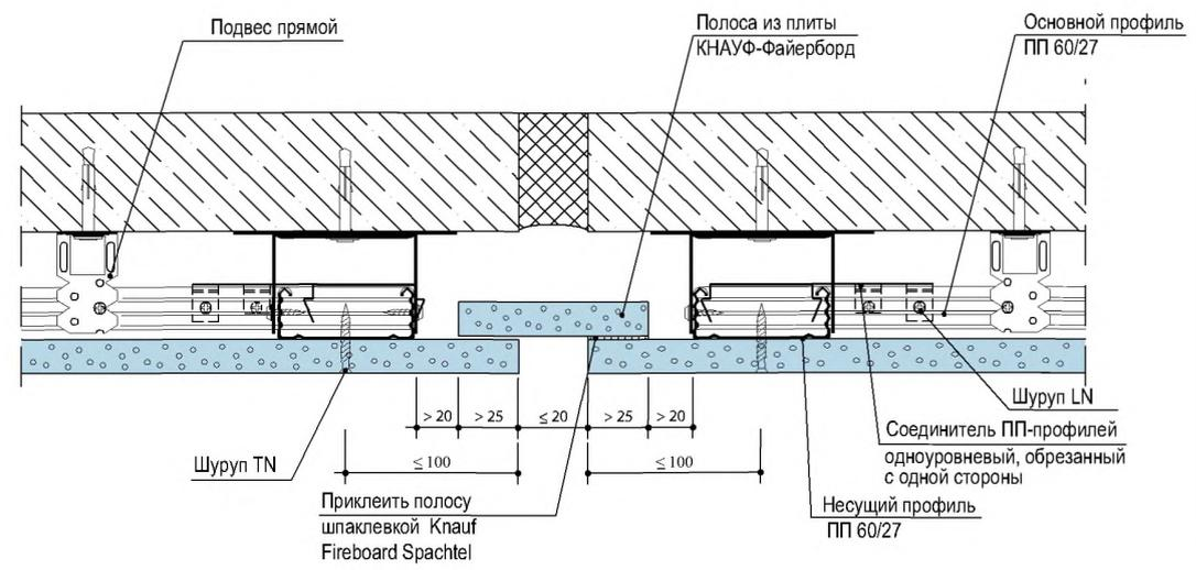
Деформационный шов устраивать через каждые 15 м по длине подвесного потолка и в местах устройства деформационного шва несущих конструкций.
