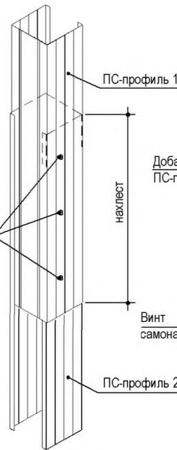
2 ПС-профиля, соединенных встык и объединенных в виде коробки дополнительным ПС-профилем
