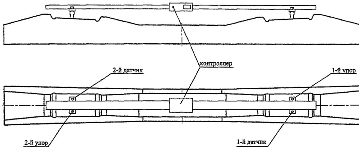
Рис. 76 Схема контроля пропеллерности подрельсовых площадок прибором ПКПИ-01Ш
