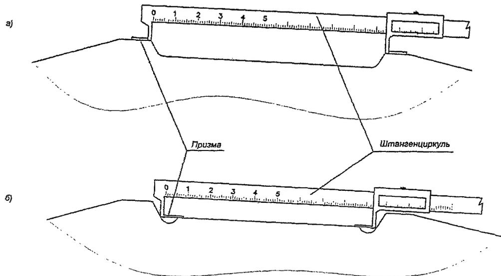
Рис.2 Схема измерений расстояний по оси шпалы между упорными плоскостями углубления подрельсовой площадки до конца шпалы:
