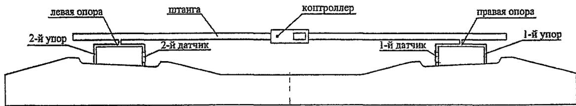
Рис. 66 Схема контроля подуклонки подрельсовых площадок прибором ПКУ-01Ш
