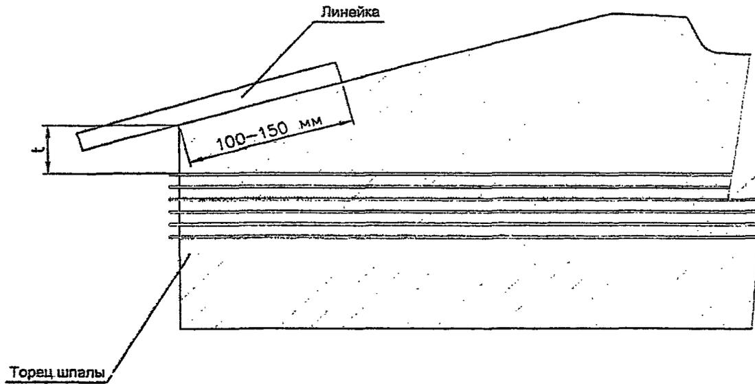
Рис. 11 Схема определения толщины  $t$  защитного слоя бетона
