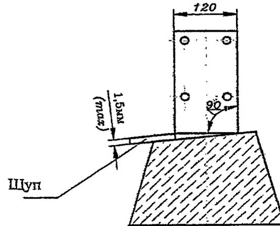
Рис. 7а Схема контроля пропеллерности подрельсовых площадок шпалы
