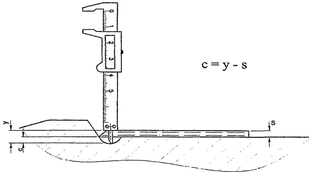
Рис. 8 Схема контроля глубины  $C$  выкружки подрельсовой площадки
