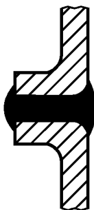
Рисунок А.5.1 — Зона распыления. Склепанное соединение
