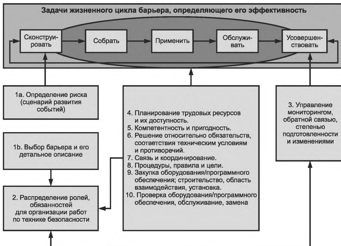
Рисунок 12 — Структурные элементы менеджмента безопасности организации относительно задачи управления жизненным циклом барьеров безопасности. Овал охватывает оценку определения эффективности защитных барьеров
