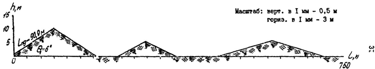
Рис. 8. Продольный профиль трассы пролегания трубопровода
