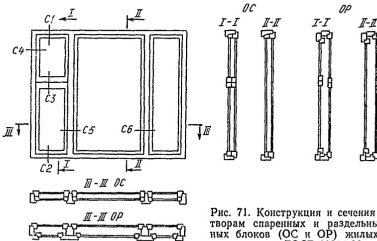
Рис. 71. Конструкция и сечения по приворотам спаренных и отдельных оконных блоков (OC и OP) жилых зданий по ГОСТ 11214-86
