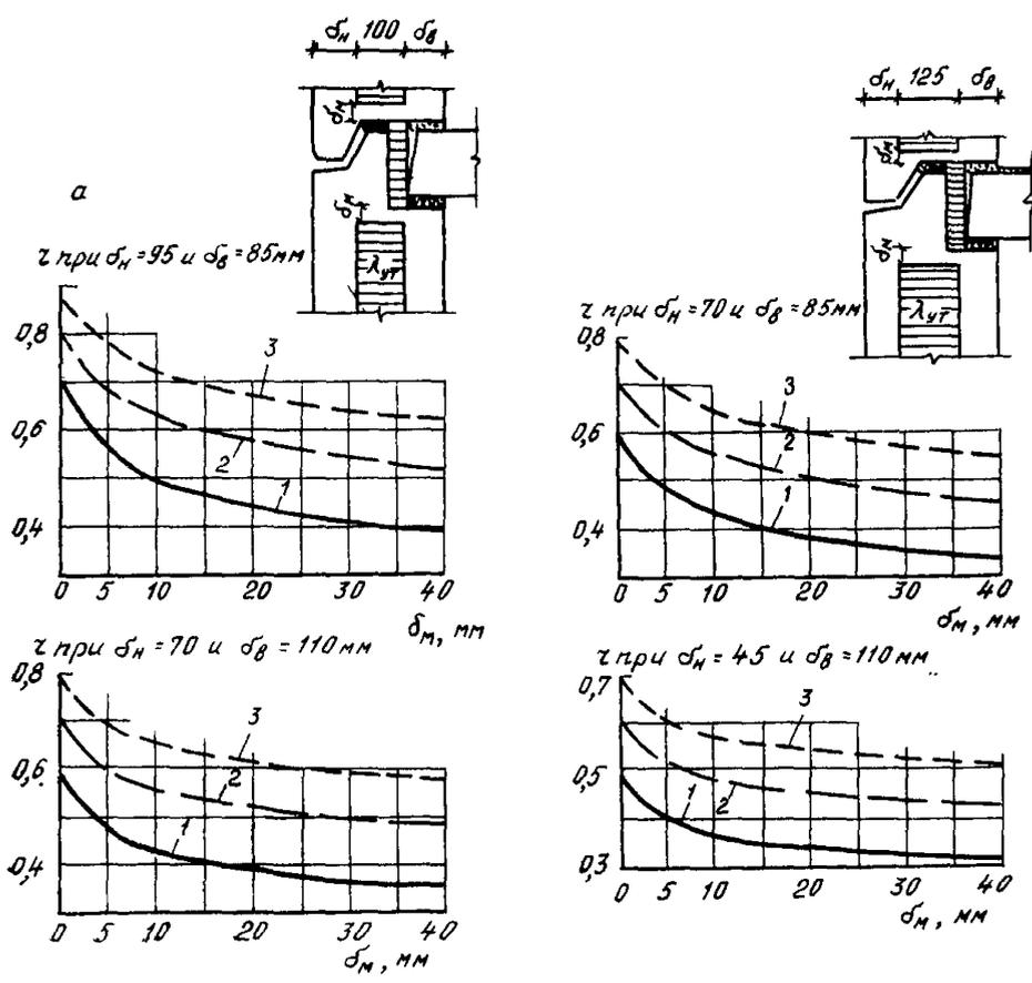
Рис. 29. Определение  $r$  участка трехслойной панели из бетона над про-
