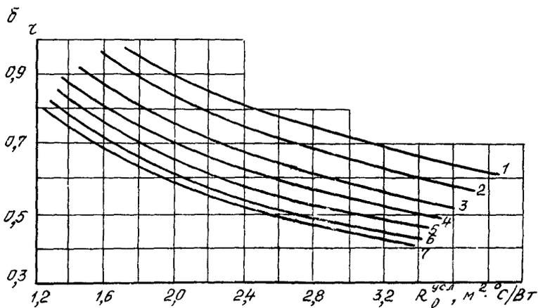
Рис. 32. Определение  $r$  простенка трехслойной панели из керамзитобетона толщиной 350 мм при  $L=500$  мм (а) и 650 мм (б):
