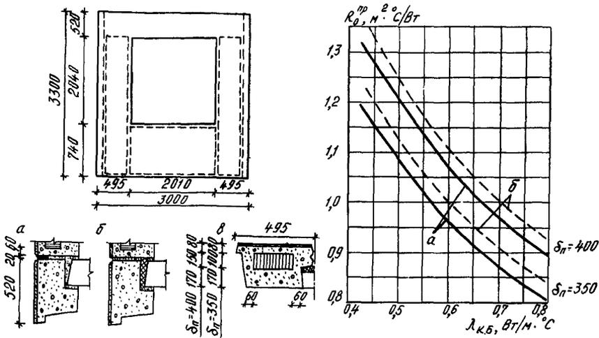
Рис. 39. Приведенное сопротивление теплопередаче  $R_0^{np}$  трехслойной керамзитобетонной панели с неутепленной перемычкой ( $\delta_n = 350$  и  $400$  мм) с колодцеобразным вертикальным стыком при  $F_{\Pi}/F_{o.п} = 2,41$ :
