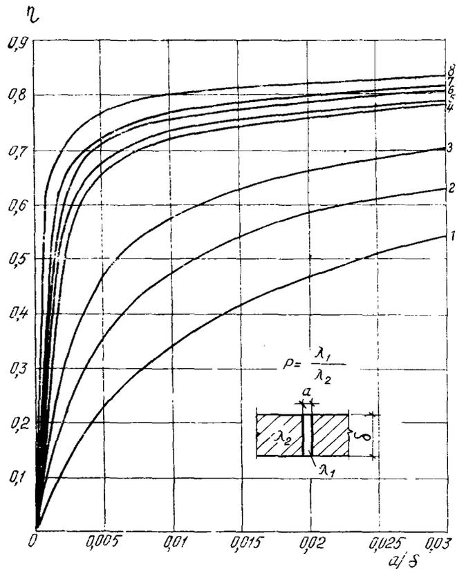
Рис. 53. График определения  $\eta$  для металлических включений I типа:
