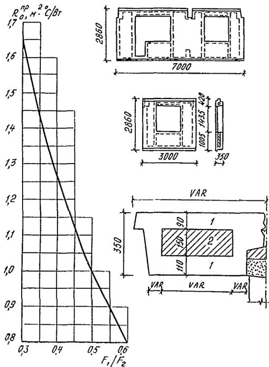
Рис. 1. Зависимость  $R_0^{np} = f(F_1/F_2)$  трехслойных керамзитобетонных наружных стен по альбому БРС41-39 МНИИТЭПа:
