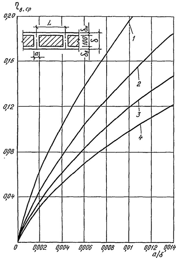
Рис. 65. График определения  $\eta_{\delta,ср}$  для параллельно расположенных металлических включений II типа при  $\delta_{ут} = 100$  мм:
