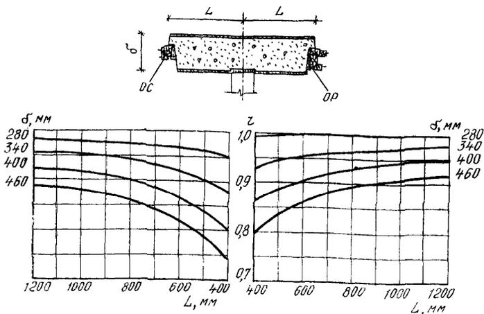
Рис. 7. Определение  $r$  простенка промежуточного примыкания двухмодульной панели при спаренных и раздельных оконных блоках
