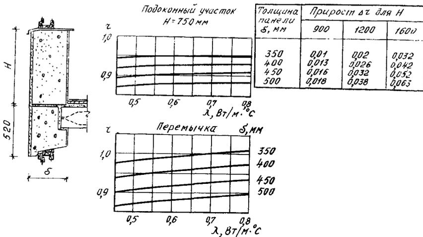
Рис. 10. Определение  $r$  подоконного участка и надоконной перемычки стеновой панели с горизонтальным стыком без утеплителя и с раздельным оконным блоком (с плитой перекрытия  $\delta_{\text{п}} = 220 \text{ мм}$ )
