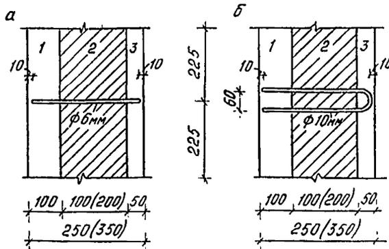
Рис. 5. Схемы расположения в стеновой панели стержневой (а) и U-образной гибкой (б) связи: 1 — керамзитобетон,  $\gamma=1800$  кг/м<sup>3</sup>,  $\lambda=0,93$  Вт/м·°С; 2 — утеплитель,  $\lambda_{ут}$  см. табл; 3 — пескобетон,  $\gamma=2200$  кг/м<sup>3</sup>,  $\lambda=1,4$  Вт/м·°С
