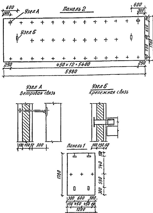
Рис. 4. Схема раскладки гибких связей в межкомнатной вставке (панель 1) и ленточной панели (панель 2) для плодоовощных баз
