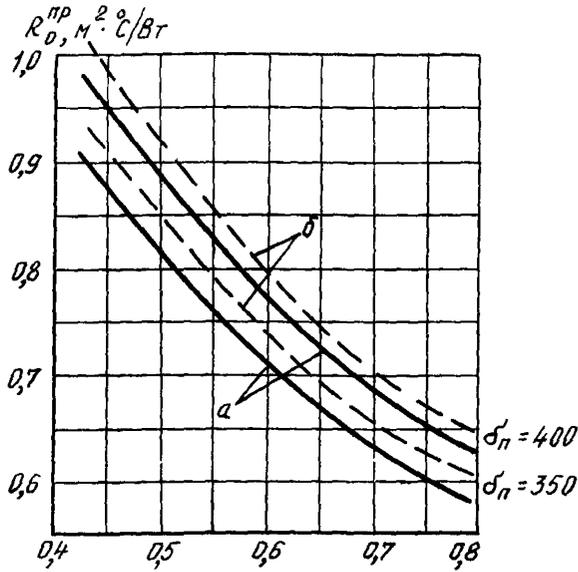
Рис. 19. Приведенное сопротивление теплопередаче  $R_0^{np}$  однослойных панелей ( $\delta_n = 350$  и  $400$  мм) с плоским вертикальным стыком:
