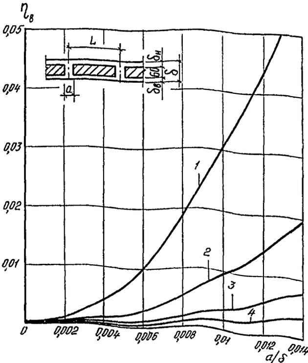
Рис. 62. График определения  $\eta_v$  для параллельно расположенных металлических включений II типа при  $\delta_{ут} = 60$  мм:
