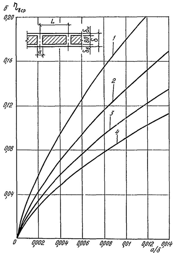
Рис. 64. График определения  $\eta_{\delta, \text{ср}}$  для параллельно расположенных металлических включений II типа при  $\delta_{\text{ут}} = 60$  мм (а) и  $\delta_{\text{ут}} = 80$  мм (б):
