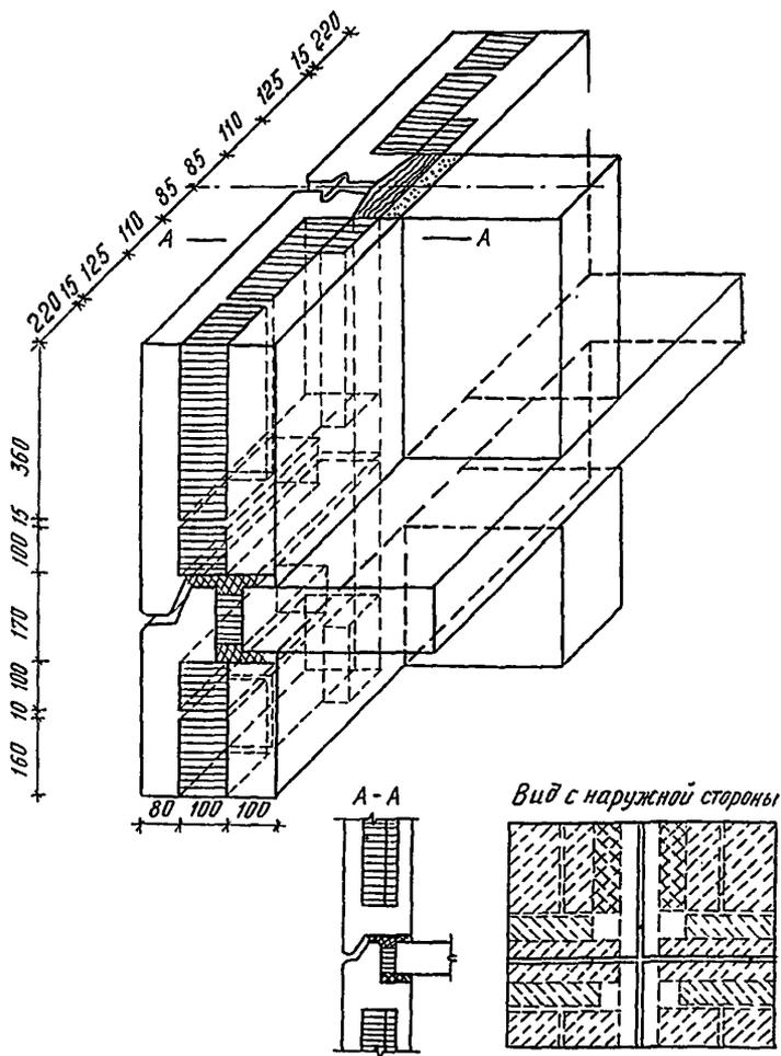
Рис. 13. Раскладка утеплителя в объемном узле сопряжения панелей НЗ6-8т (проектное решение)
