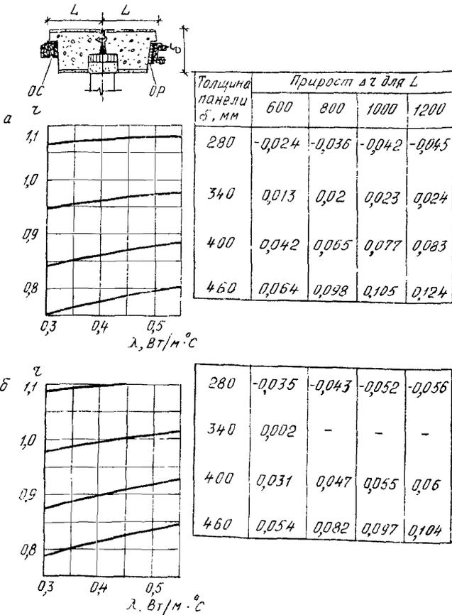
Рис. 4. Определение  $\gamma$  простенка однослойной стеновой панели с утепленным колодецеобразным вертикальным закрытым стыком при спаренных (а) и раздельных (б) оконных блоках,  $L=400$  мм
