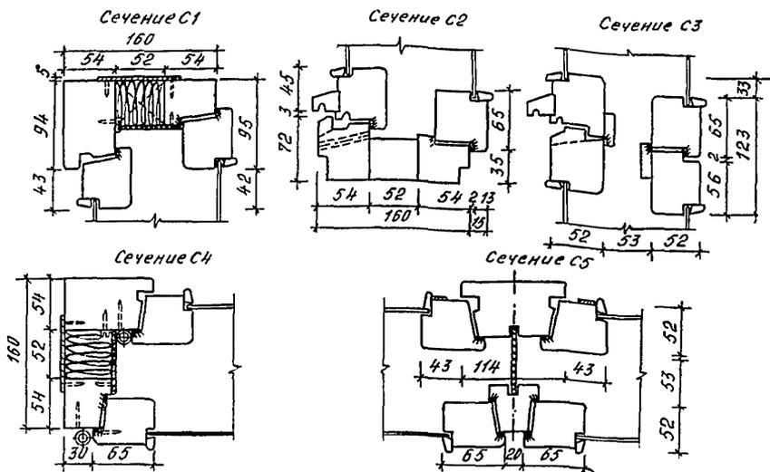
Рис. 75. Сечения С1, С2, С3, С4, С5 (см. рис. 71) по притворам оконных блоков с двойным остеклением со звукопоглощающей обкладкой по альбому МНИИТЭП РМ-1372, доп. 1
