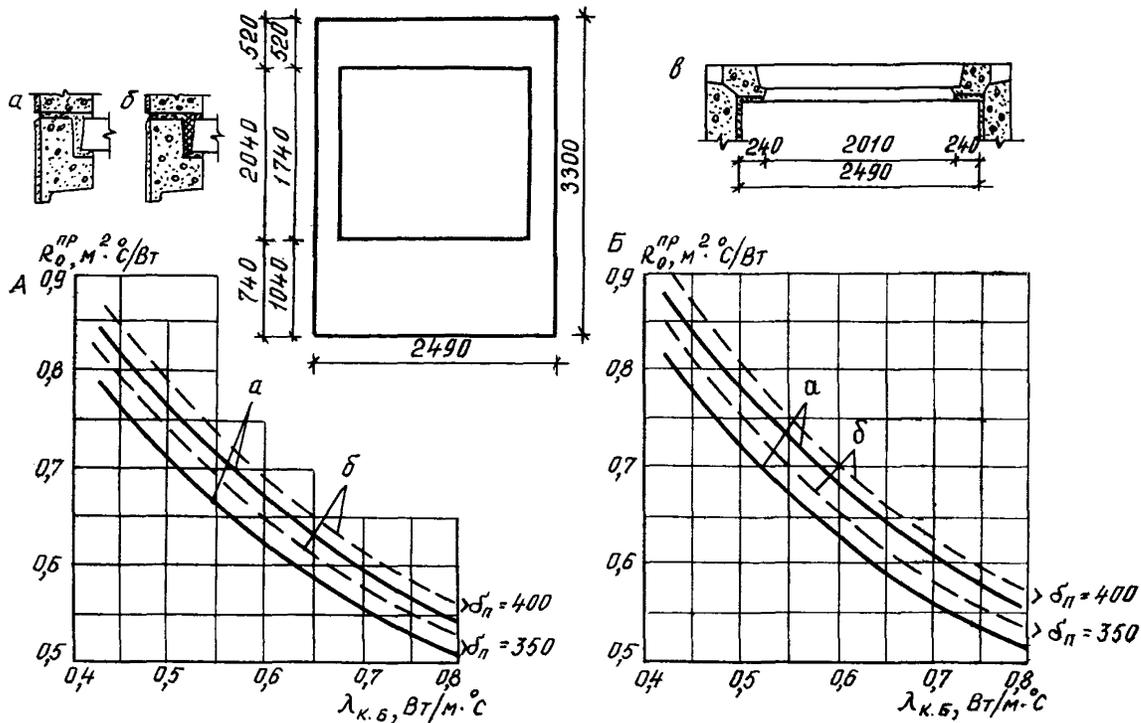
Рис. 20. Приведенное сопротивление теплопередаче  $R_0^{np}$  однослойных керамзитобетонных панелей внутреннего угла при  $F_n/F_{0.п} = 2,0$  (А) и  $F_n/F_{0.п} = 2,35$  (Б):
