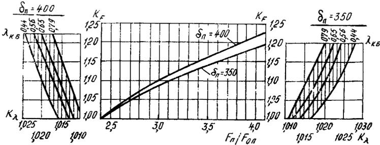
Рис. 42. Графики для определения повышающих коэффициентов  $K_F$  и  $K_λ$  при выявлении  $R_0^{np}$  трехслойных панелей с неутепленной перемычкой в случае изменения  $F_n/F_{оп}$  и  $λ_{ут}$  с 0,047 на 0,041 Вт/м. $^{\circ}$ С
