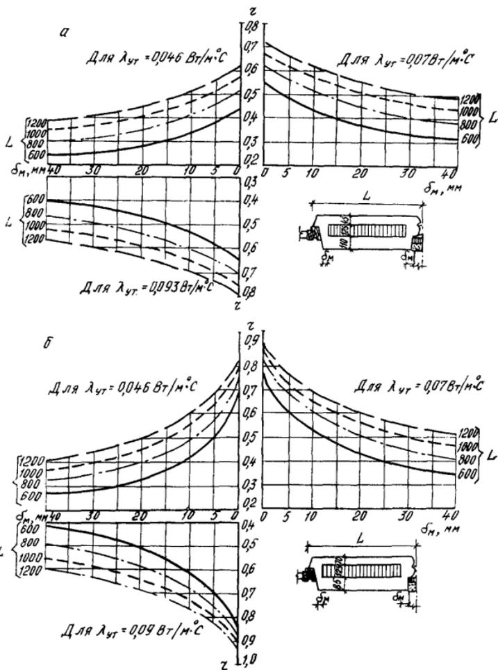
Рис. 27. Определение  $\gamma$  простенка бетонной трехслойной панели с обрамляющими ребрами при  $\delta_{yt} = 125 \text{ мм}$ ,  $\delta_v = 110 \text{ мм}$  и  $\delta_n = 45 \text{ мм}$  (а);  $\delta_{yt} = 125 \text{ мм}$ ,  $\delta_v = 85 \text{ мм}$  и  $\delta_n = 70 \text{ мм}$  (б)
