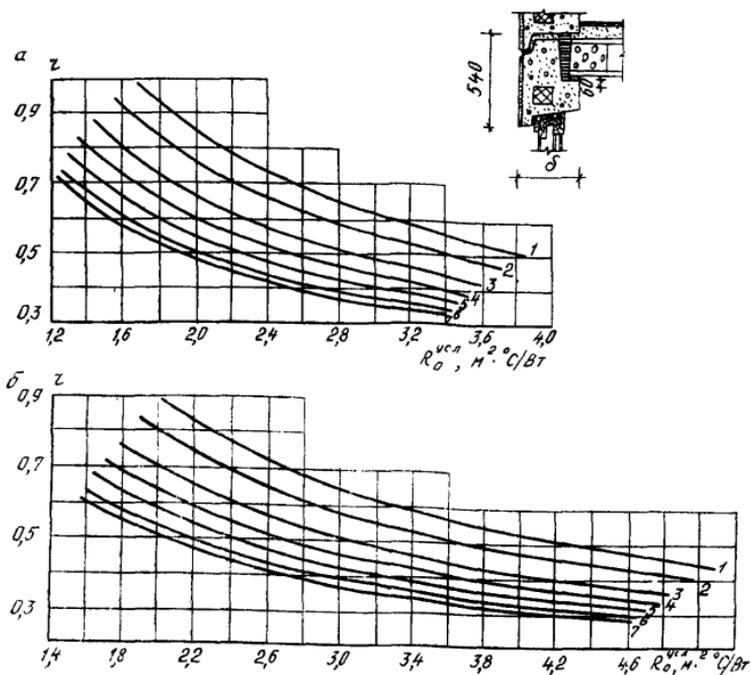
Рис. 38. Определение  $r$  надоконной перемычки трехслойной панели из керамзитобетона при  $\delta=350$  мм (а) и 400 мм (б):
