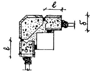
Рис. 23. Определение  $\gamma$  ограждений наружного угла:
