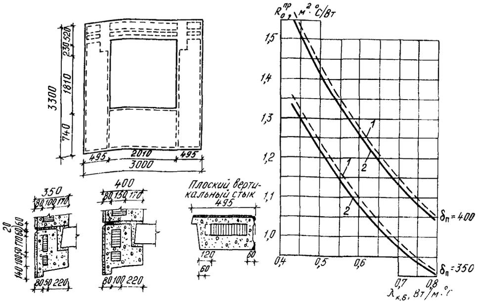
Рис. 44. Приведенное сопротивление теплопередаче  $R_0^{np}$  трехслойной керамзитобетонной панели ( $\delta_n = 350$  и  $400$  мм) при  $\lambda_{ут} = 0,041$  и  $0,047$  Вт/м·°С и плоском вертикальном стыке ( $F_n / F_{o.n} = 2,41$ ):
