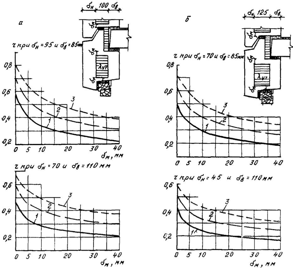
Рис. 28. Определение  $r$  надоконной перемычки трехслойной панели из бетона при  $\delta_{\text{ут}} = 100$  мм (а) и  $\delta_{\text{ут}} = 125$  мм (б):
