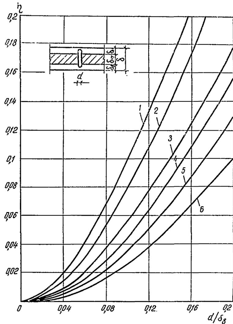
Рис. 68. График определения  $\eta$  для металлических включений V типа (гибкая связь) при разных значениях  $\delta_{ур}/\delta_v$  :
