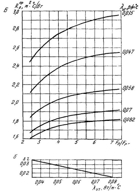
Рис. 50. Определение  $R_0^{np}$  одномодульной панели с гибкими связями в зависимости от  $\lambda_{yt} / F_{\text{пи}}$  и  $F_{\text{о.я}}$  при  $\delta_{\text{н}} = 350$  мм,  $\delta_{\text{yt}} = 100$  мм (А) и при  $\delta_{\text{н}} = 400$  мм,  $\delta_{\text{yt}} = 150$  мм (Б) и соответствующие поправочные коэффициенты (а и б) для пересчета  $R_0^{np}$  одномодульной панели на двухмодульную
