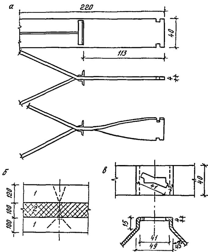
Рис. 7. Гибкая связь с автоматической фиксацией слоев:
