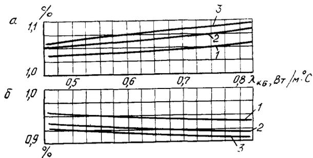
Рис. 47. Поправочный коэффициент на  $R_0^{np}$  при изменении  $\delta_M$  с 50 мм на  $\delta_M=30$  мм (а) и  $\delta_M=80$  мм (б):
