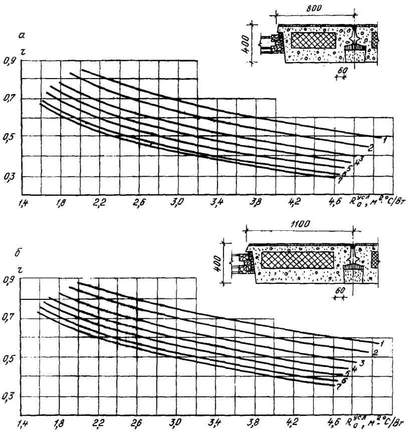
Рис. 35. Определение  $g$  простенка трехслойной панели из керамзитобетона толщиной 400 мм при  $L=800$  мм (а) и 1100 мм (б):
