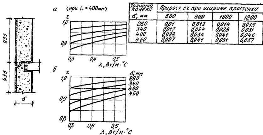
Рис. 13. Определение  $r$  угловых участков под окном (а) и над окном (б) стеновой панели с утепленным горизонтальным стыком (со сплошной плитой перекрытия  $\delta_{п} = 140$  мм) при  $L = 400$  мм
