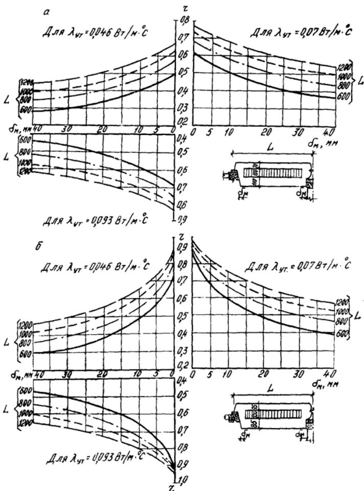
Рис. 26. Определение  $\gamma$  простенка бетонной трехслойной панели с обрамляющими ребрами при  $\delta_{\text{ут}} = 100 \text{ мм}$ ,  $\delta_{\text{в}} = 110 \text{ мм}$  и  $\delta_{\text{н}} = 70 \text{ мм}$  (а) и  $\delta_{\text{ут}} = 100 \text{ мм}$ ,  $\delta_{\text{в}} = 85 \text{ мм}$  и  $\delta_{\text{н}} = 95 \text{ мм}$  (б)
