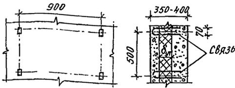
**Рис. 11.** Определение  $\gamma$  керамзитобетонной конструкции  $\delta=350-400$  мм в зависимости от  $\delta_{ут}$ ,  $\lambda_{ут}$  и диаметра U-образной металлической связи:
