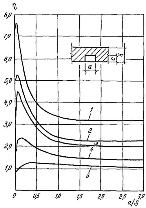
Рис. 66. График определения  $\eta$  для бетонных включений III типа:
