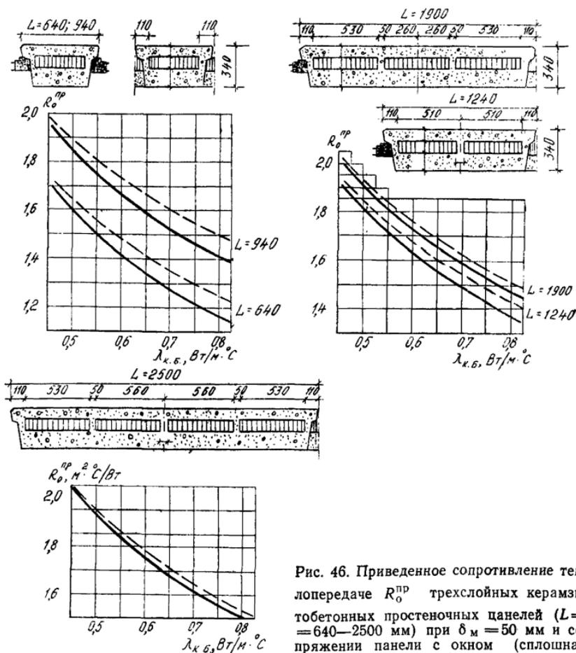
Рис. 46. Приведенное сопротивление теплопередаче  $R_0^{np}$  трехслойных керамзитобетонных простеночных панелей ( $L = 640 - 2500$  мм) при  $\delta_m = 50$  мм и сопряжении панели с окном (сплошная линия) и со стыком (пунктирная линия).
