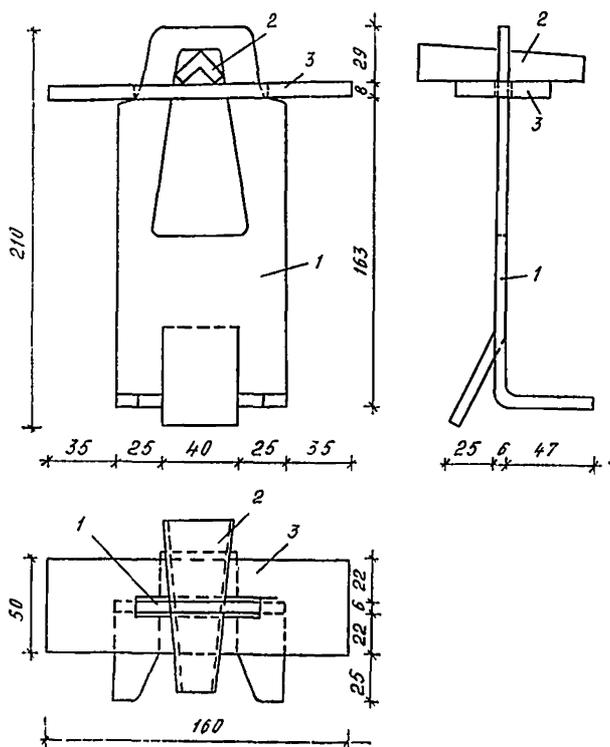
Рис. 8. Универсальная штампованная закладная деталь ШЗД-1:
