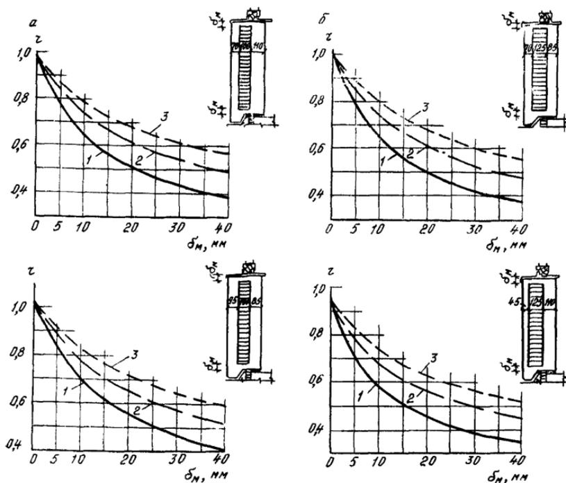
Рис. 25. Определение  $r$  подоконного участка трехслойной бетонной панели с обрамляющими ребрами при  $\delta_{\text{ут}} = 100$  мм (а) и  $\delta_{\text{ут}} = 125$  мм (б):
