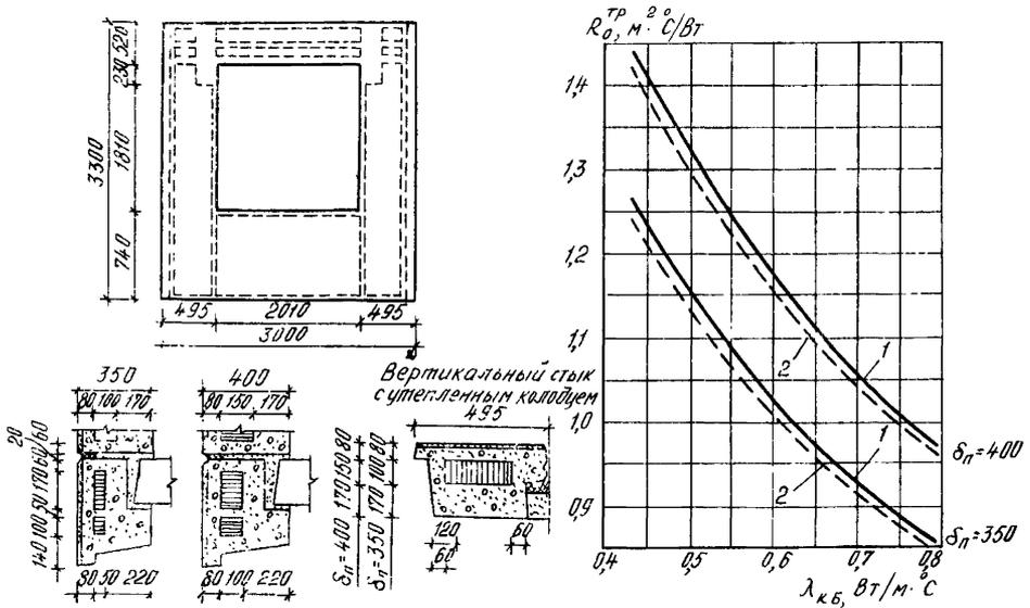
Рис. 43. Приведенное сопротивление теплопередаче  $R_0^{np}$  трехслойной керамзитобетонной панели ( $δ_n = 350$  и  $400$  мм) при  $λ_{ут} = 0,041$  и  $0,047$  Вт/м. $^{\circ}$ С и утепленном колодезном стыке ( $F_n/F_{оп} = 2,41$ ):
