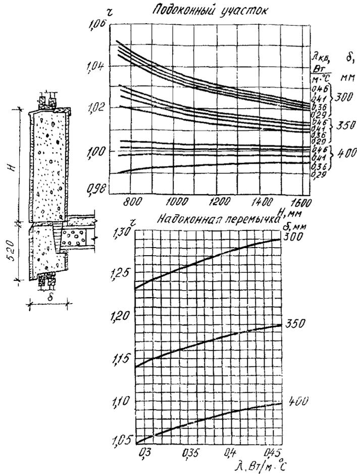
Рис. 11. Определение  $\lambda$  подоконного участка и надоконной перемычки стеновой панели с утепленным горизонтальным стыком при отдельных оконных блоках (с плитой перекрытия  $\delta_{\text{п}}=220$  мм)
