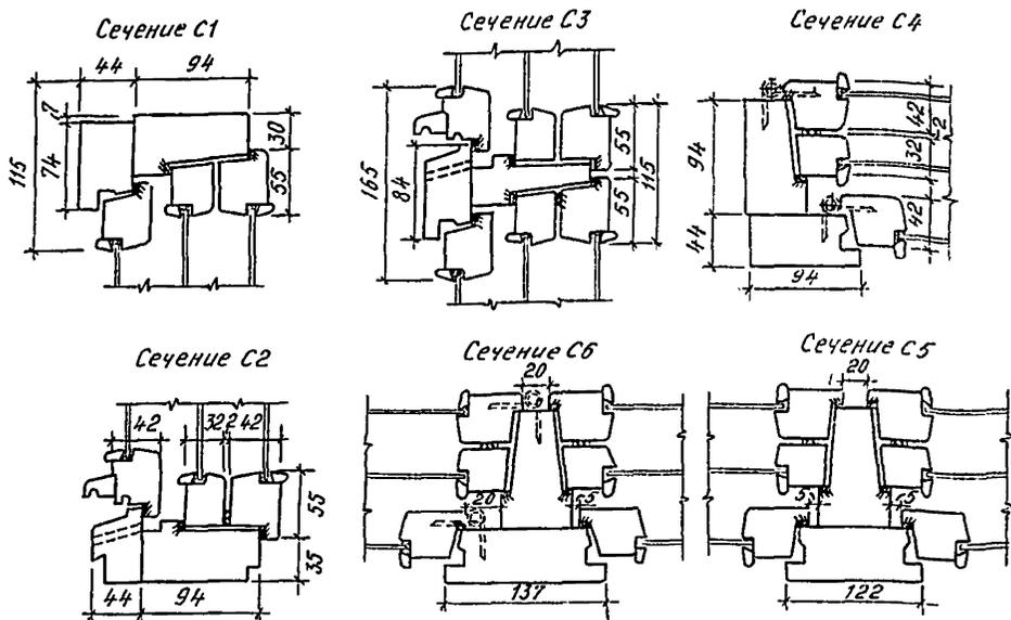
Рис. 74. Сечения С1, С2, С3, С4, С5, С6 (см. рис. 71) по притворам оконных блоков с тройным остеклением
