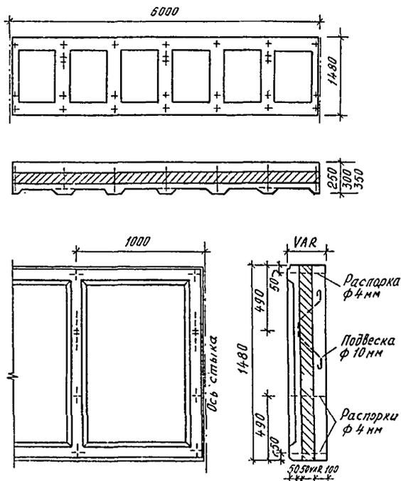
Рис. 2. Конструкция панели полосовой разрезки домов серии I.030.I-1:
