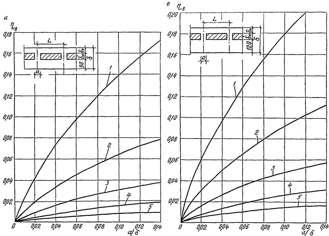
Рис. 58. График определения  $\eta_b$  для параллельно расположенных бетонных включений II типа при  $\delta_b = 90$  мм (а) и  $\delta_b = 120$  мм (б):
