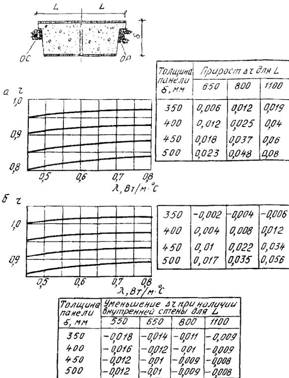
Рис. 6. Определение  $\gamma$  простенка однослойной стеновой панели с прямым вертикальным стыком при спаренных (а) и отдельных (б) оконных блоках,  $L=550$  мм
