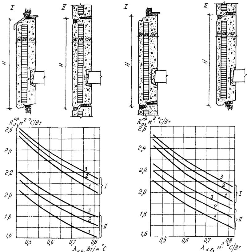
Рис. 48. Приведенное сопротивление теплопередаче  $R_0^{np}$  трехслойной керамзитобетонной панели полосовой разрезки различной высоты и при разных вариантах сопряжения:
