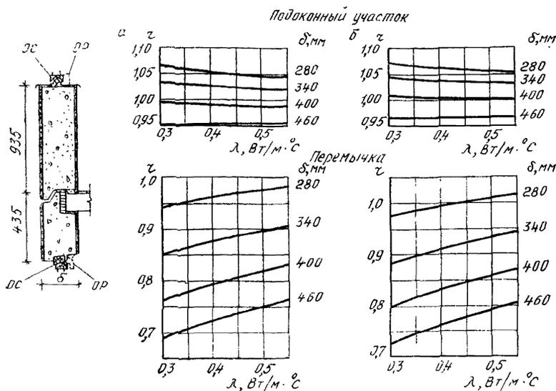
Рис. 8. Определение  $r$  подоконного участка и надоконной перемычки с утепленным горизонтальным стыком и сплошной плитой перекрытия ( $\delta_n = 140$  мм) при спаренных (а) и раздельных (б) оконных блоках
