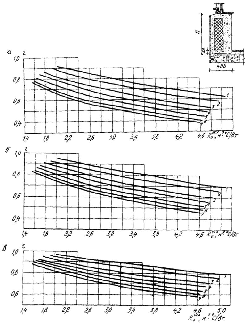
Рис. 37. Определение  $r$  подоконного участка трехслойных панелей из керамзитобетона толщиной 400 мм при  $H=735$  мм (а), 1035 мм (б), 1635 мм (в):
