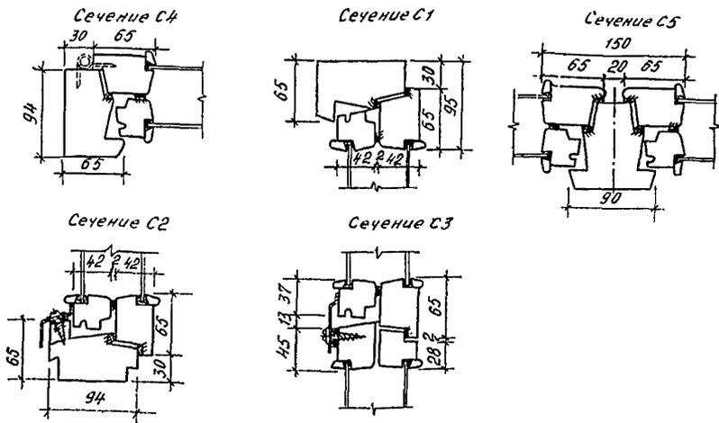
Рис. 76. Сечения С1, С2, С3, С4, С5 (см. рис. 71) по притворам модернизированных оконных блоков со спаренными переплетами по альбому МНИИТЭП, шифр НИ-3003-01
