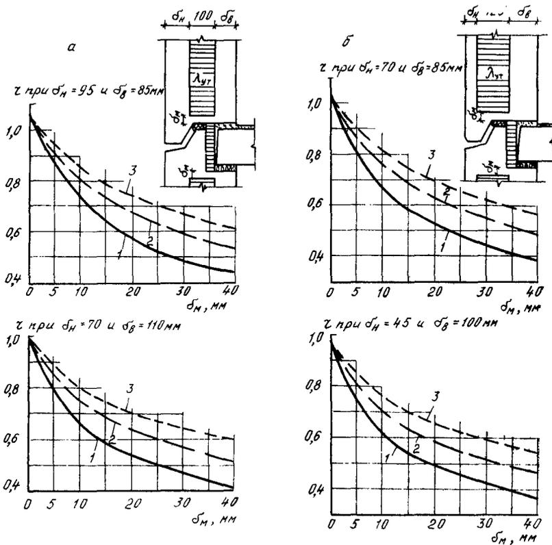
Рис. 30. Определение  $r$  участка трехслойной панели из бетона под простенком при  $\delta_{ут} = 100$  мм (а) и  $\delta_{ут} = 125$  мм (б):
