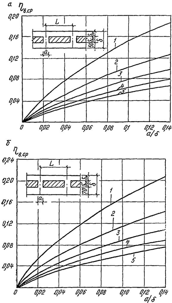
Рис. 59. График определения  $\eta_{в,ср}$  для параллельно расположенных бетонных включений II типа при  $\delta_{в} = 50$  мм (а) и  $\delta_{в} = 70$  мм (б):
