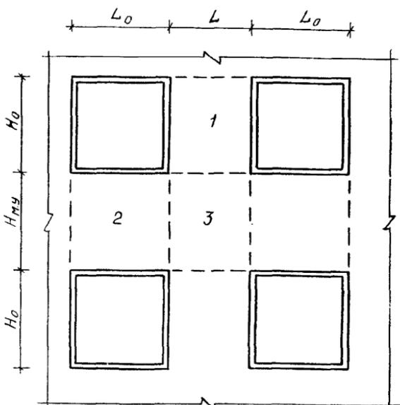
Рис. 1. Схема разбивки площадей расчетных участков кирпичной стены для определения  $R_o^{np}$  :
