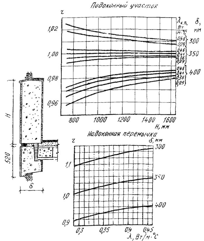
Рис. 12. Определение  $\lambda$  подоконного участка и надоконной перемычки стеновой панели с утепленным горизонтальным стыком при спаренных оконных блоках (с плитой перекрытия  $\delta_{\text{п}}=220$  мм)
