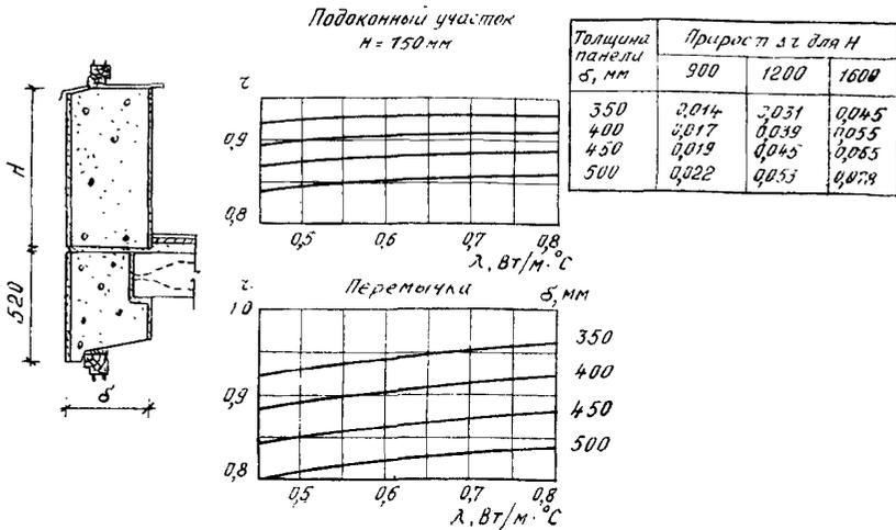
Рис. 9. Определение  $r$  подоконного участка и надоконной перемычки стеновой панели с горизонтальным стыком без утеплителя и со спаренным оконным блоком (с плитой перекрытия  $\delta_{\text{п}} = 220 \text{ мм}$ )
