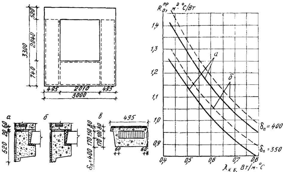
Рис. 41. Приведенное сопротивление теплопередаче  $R_{0,1}^{np}$  трехслойной керамзитобетонной панели с неутепленной перемычкой ( $\delta_n = 350$  и  $400$  мм) и плоским вертикальным стыком при  $F_n/F_{o.n} = 2,41$ :
