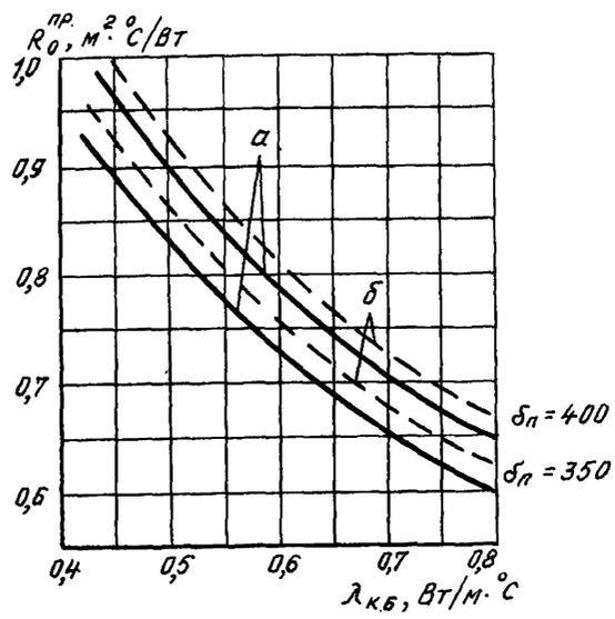
Рис. 18. Приведенное сопротивление теплопередаче  $R_0^{np}$  однослойных панелей ( $\delta_n = 350$  и  $400$  мм) с колодезобразным вертикальным стыком: а — горизонтальный стык с раствором; б — то же, со вспененным утеплителем; в — вертикальный стык с утепленным колодцем
