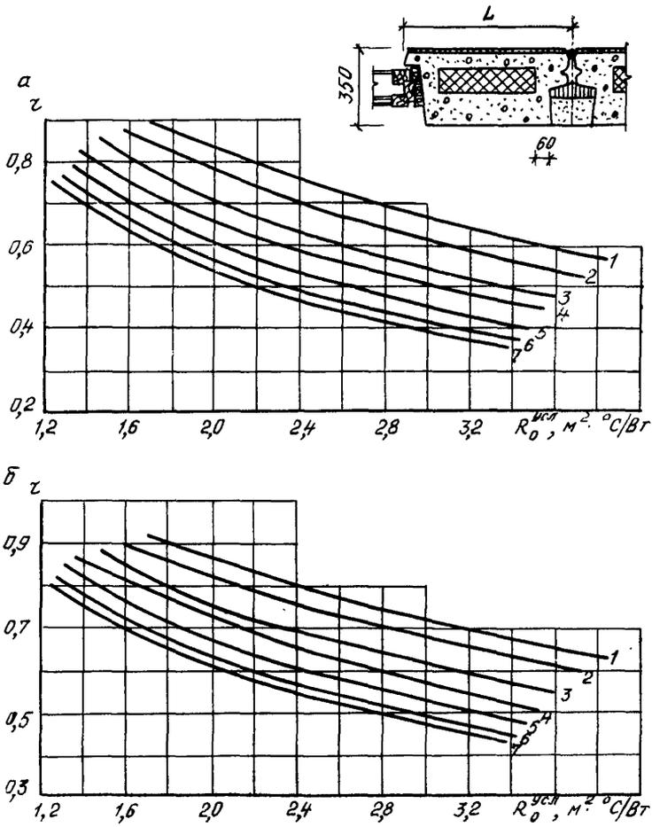
Рис. 33. Определение  $r$  простенка трехслойной панели из керамзитобетона толщиной 350 мм при  $L=800$  мм (а) и 1100 мм (б):
