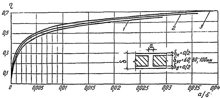
Рис. 55. График определения коэффициента  $\eta$  для единичных металлических включений II типа:
