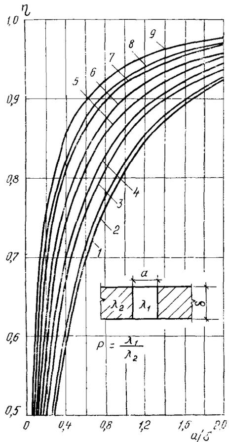
Рис. 52. График определения  $\eta$  для бетонных включений I типа:
