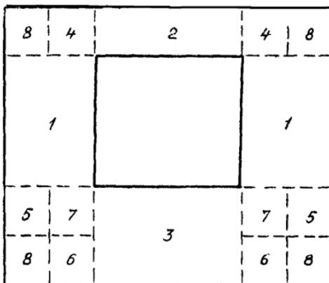
Рис. 24. Схема разбивки площадей расчетных участков трехслойной панели с жесткими связями для определения  $r$
