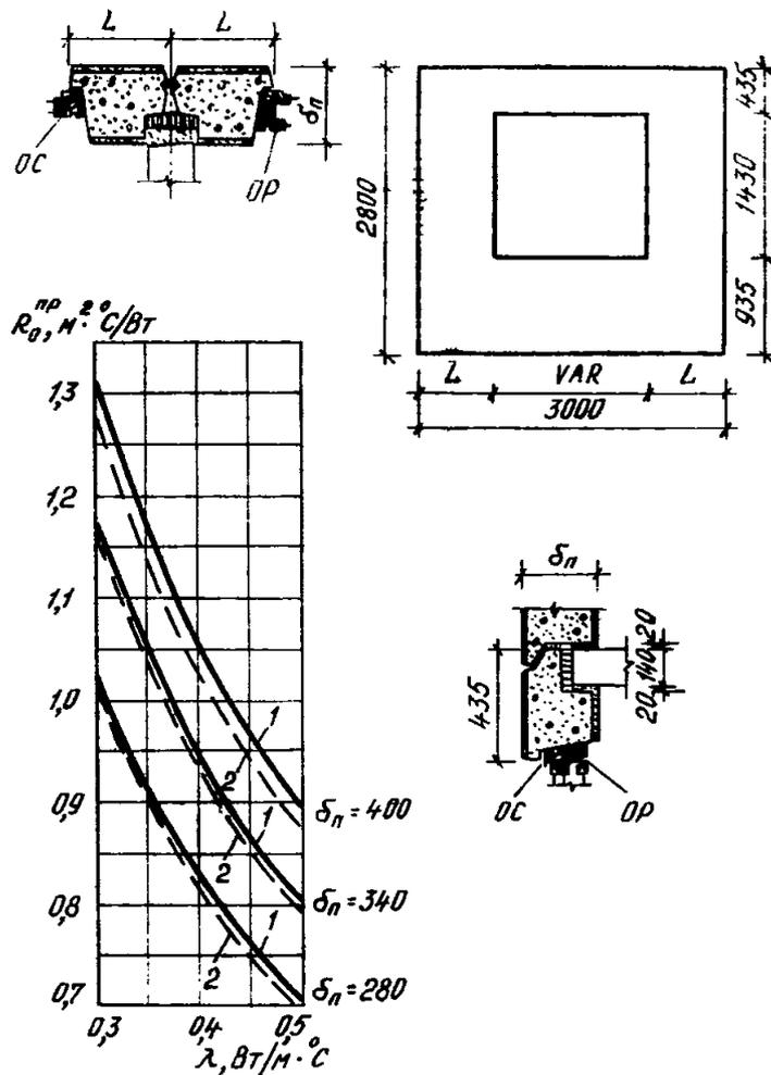
Рис. 17. Приведенное сопротивление теплопередаче  $R_0^{np}$  однослойных керамзитобетонных панелей при междуэтажном перекрытии из сплошной плиты толщиной 140 мм:
