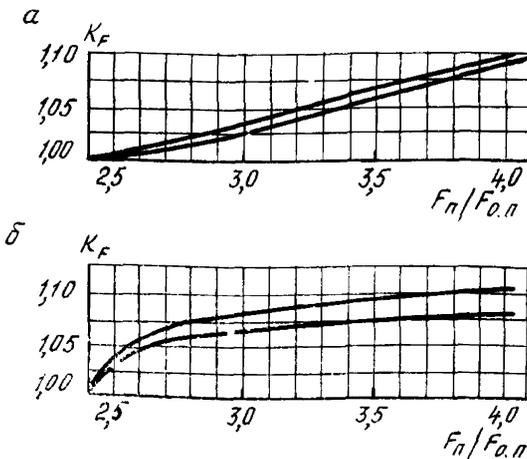
Рис. 45. Графики для определения повышающего коэффициента  $K$  при выявлении  $R_0^{np}$  трехслойных панелей в случае изменения  $F_n / F_{o.n}$  и при разной конфигурации вертикального стыка:
