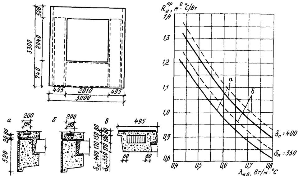
Рис. 40. Приведенное сопротивление теплопередаче  $R_{0,1}^{np}$  трехслойной керамзитобетонной панели с неутепленной перемычкой ( $\delta_n = 350$  и  $400$  мм) с утолщенным утеплителем в подоконном участке и с колодцеобразным стыком при  $F_n/F_{o.n} = 2,41$ :
