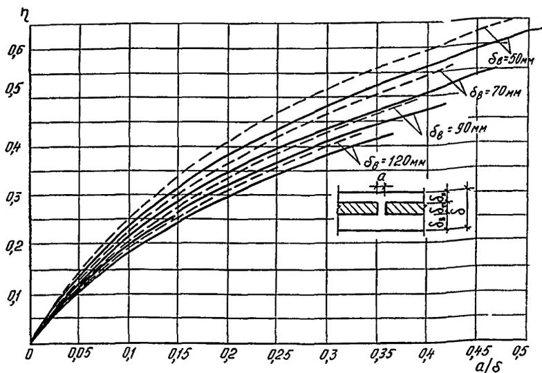
Рис. 54. График определения  $\eta$  единичных бетонных включений II типа для ограждений с  $\delta_B = 50$  мм (сплошная линия) и  $\delta_B = 70$  мм (пунктирная)
