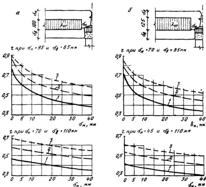
Рис. 31. Определение  $r$  участка трехслойной панели из бетона у вертикального стыка при  $\delta_{\text{ут}} = 100$  мм (а) и  $\delta_{\text{ут}} = 125$  мм (б):
