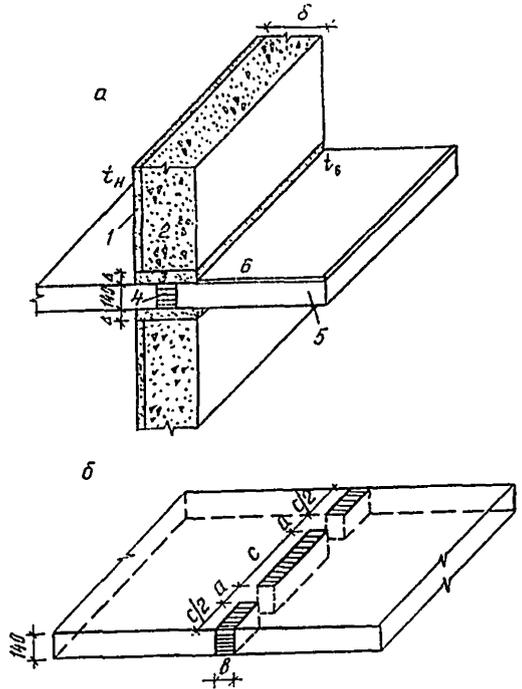
Минимальные температуры в узлах подобного типа наблюдаются над и под плитой перекрытия на цементно-песчаном растворе по оси теплопроводного включения, имеющего длину  $a$ .
