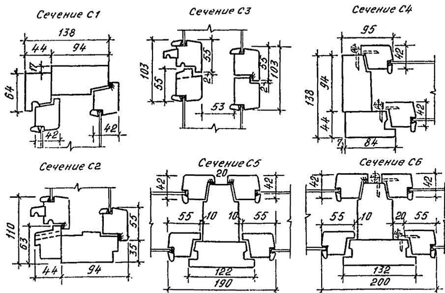
Рис. 73. Сечения С1, С2, С3, С4, С5, С6 (см. рис. 71) по притворам раздельных оконных блоков (ОР) жилых зданий
