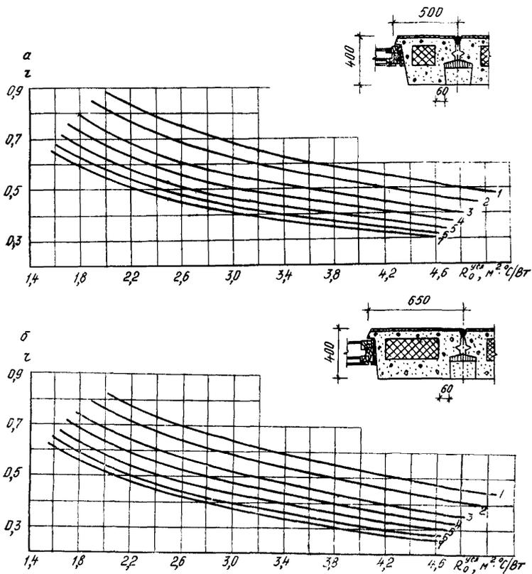
Рис. 34. Определение  $r$  простенка трехслойной панели из керамзитобетона толщиной 400 мм при  $L=500$  мм (а) и 640 мм (б):
