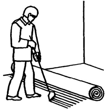
Облицовщик  $O_1$  разравнивает клей гребенкой, формируя слой толщиной 0,6-0,7 мм. При этом он оставляет на продольных стыках полотнищ намазанные полосы шириной 8-10 см
