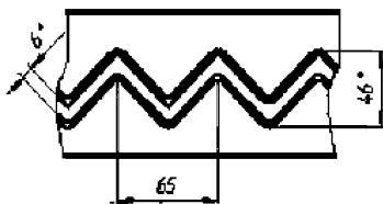
Рис. 5.2 Зигообразная выштамповка на вертикальных стенках
