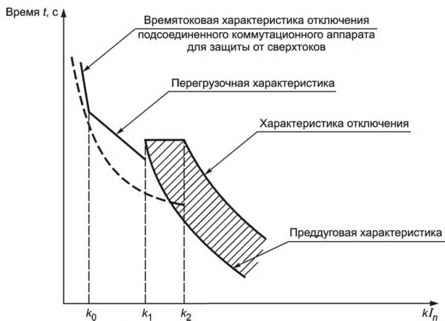
Рисунок 1 — Пример диаграммы проверки времятоковой характеристики по результатам испытаний при «пороговых» токах
