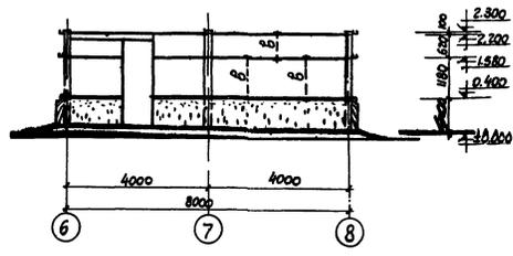
Схема элементов фазверка по оси J.
