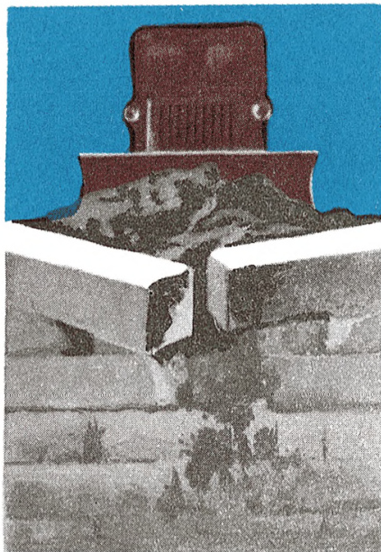
Засыпай после перекрытия подвала
