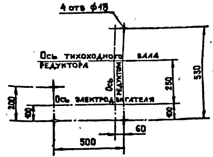
Разбивка отверстий для крепления рамы
