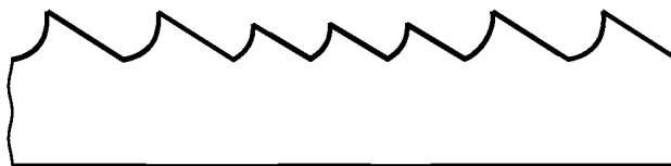
Рисунок 10 — Форма с переменным шагом зубьев
