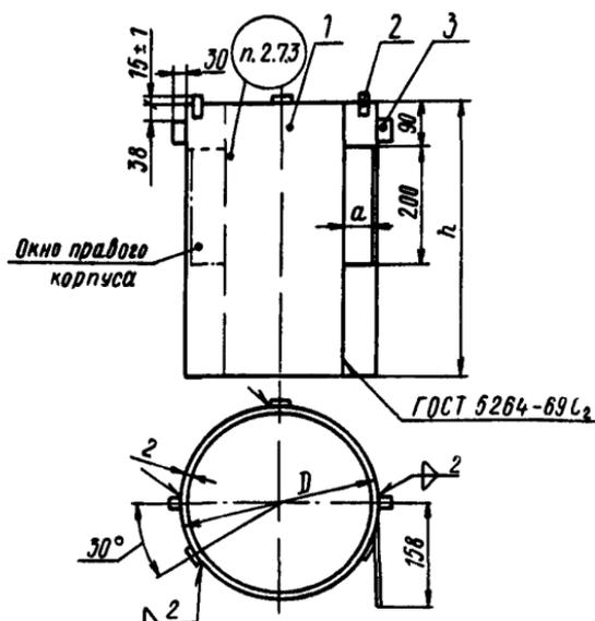
Пример условного обозначения правого циклона диаметром 350 мм и шириной патрубка  $a = 90$  мм:
