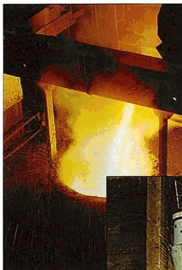
Для изготовления крестовин используется высокомарганцовистая сталь, обладающая высокой износостойкостью при ударных нагрузках и больших контактных напряжениях.
