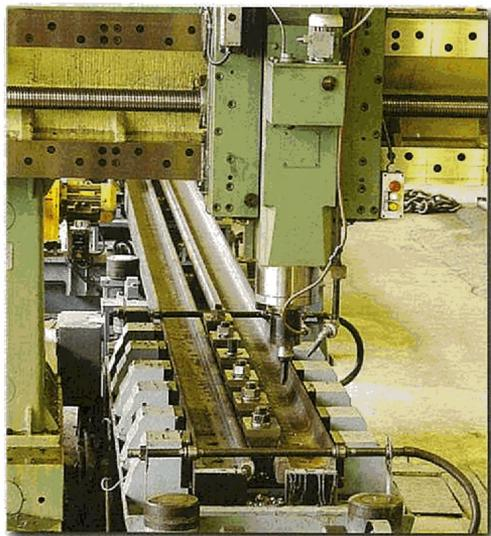
Станок с подвижной колонной и неподвижным столом, предназначен для сверления отверстий в объемно-закаленных рельсах, оснащен системой ЧПУ NC-110 и позволяет вести обработку деталей на высоких скоростях резания, с высокой точностью позиционирования осей отверстий.
