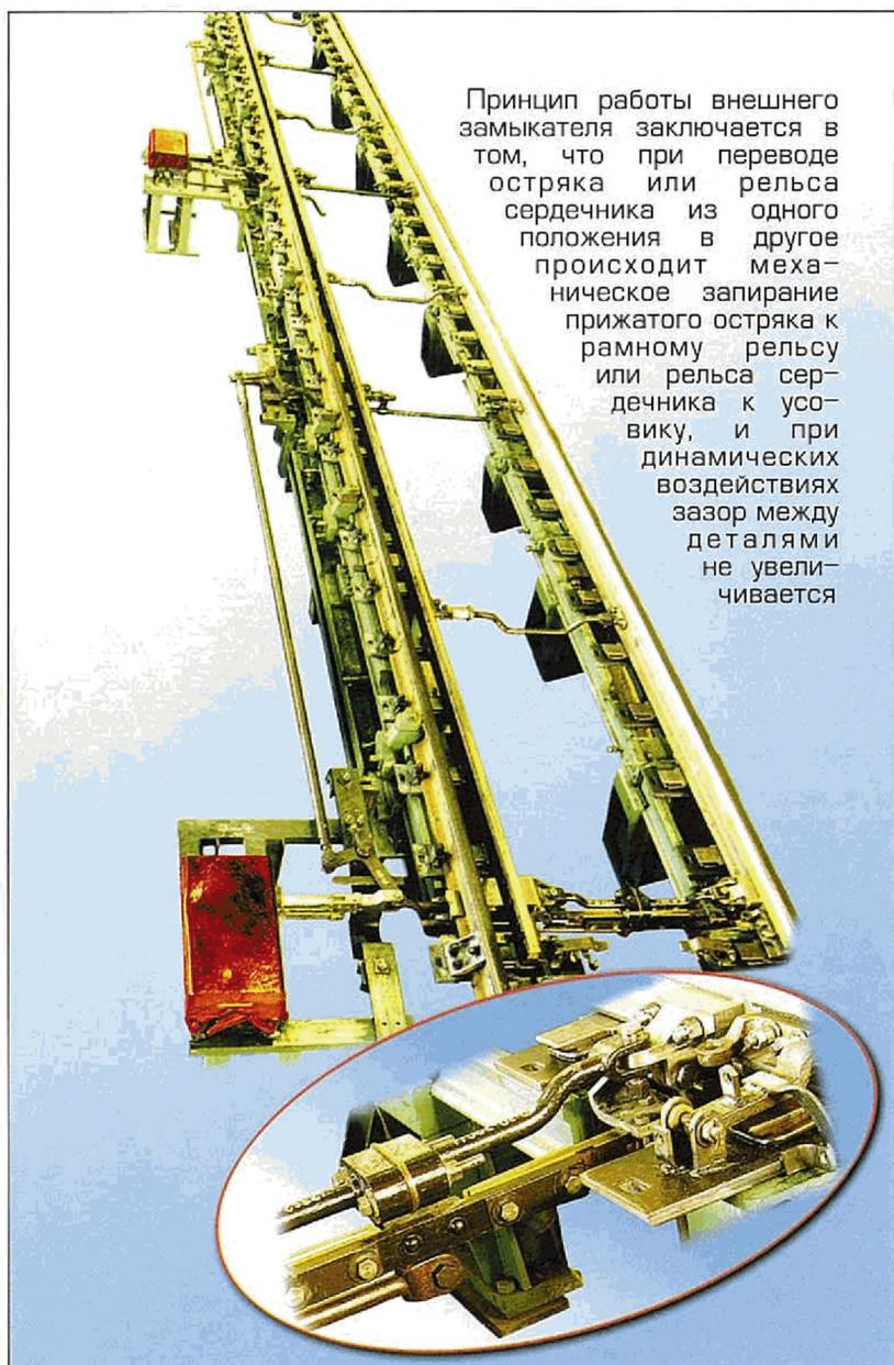
Принцип работы внешнего замыкателя заключается в том, что при переводе остряка или рельса сердечника из одного положения в другое происходит механическое запираение прижатого остряка к рамному рельсу или рельса сердечника к усовику, и при динамических воздействиях зазор между деталями не увеличивается
