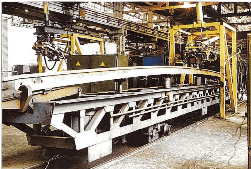
Предназначен для перевода подвижного состава с одного из параллельных путей на другой. Применяется на главных путях железнодорожных линий I и II класса со смешанным грузопассажирским движением поездов.
