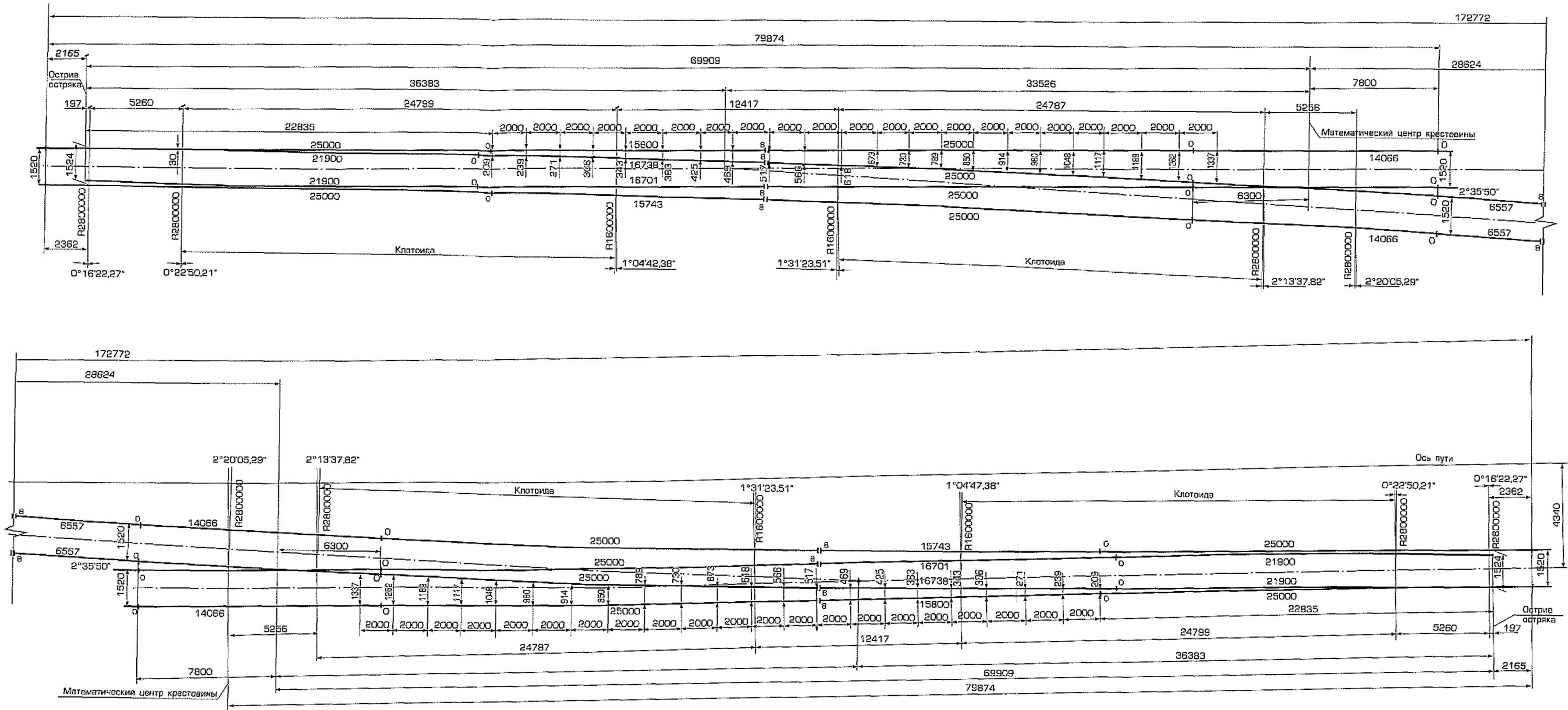
Съезд одиночный т.Р65 м.1/22. Проект ПТКБ ЦП 2833.00.000. Схема геометрических размеров.
