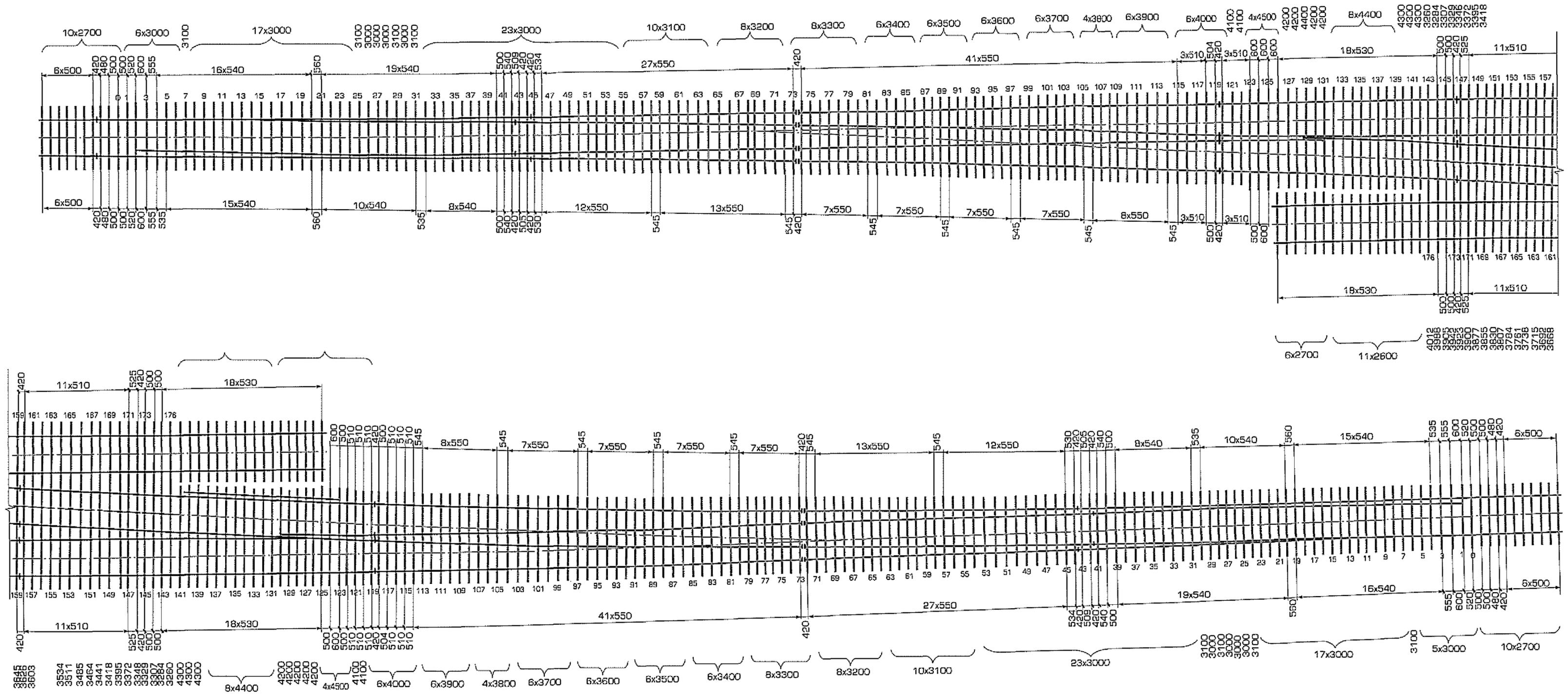
Съезд одиночный т.Р65 м.1/22 на ЖББ. Проект ПТКБ ЦП 2833.00.000. Схема укладки.
