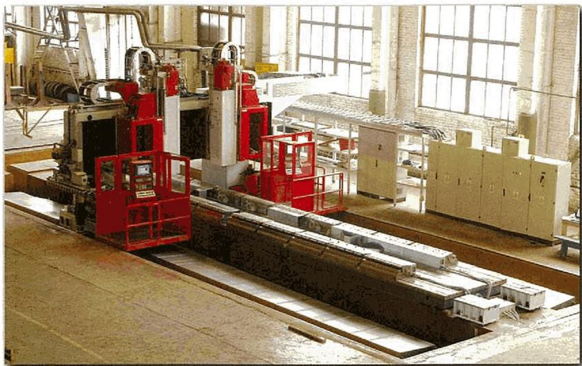
Станок с подвижным порталом и неподвижным столом, с двумя шпиндельными головками, оснащен системой ЧПУ SIEMENS 840D, специальным электромагнитным приспособлением для закрепления заготовок.
