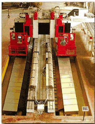
Станок позволяет вести обработку острияков повышенной твердости при высоких скоростях резания, с высокой степенью точности и чистоты обрабатываемых поверхностей.
