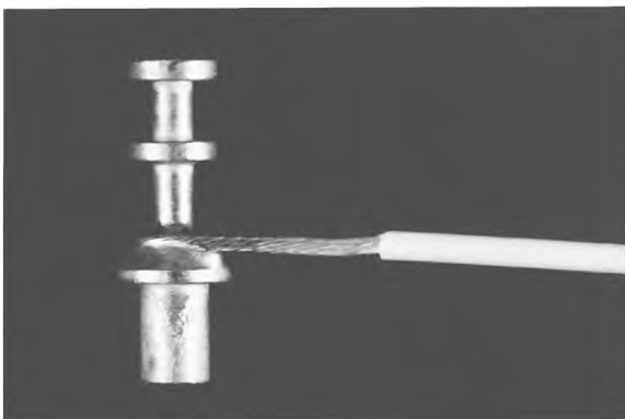
Рисунок 40 — Паяное соединение изолированного провода с контактом, большое освобождение от изоляции: виды состояний
