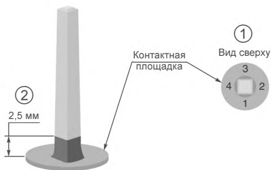
Рисунок 21 — Состояния подъема припоя: виды состояний
