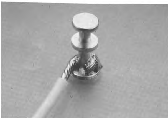
Рисунок 36 — Паяное соединение провода с контактом: недопустимое состояние
