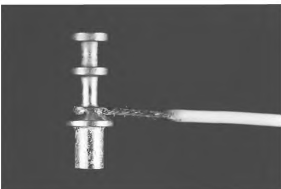
Рисунок 41 — Паяное соединение изолированного провода с контактом, чрезмерное повреждение изоляции: виды состояний
