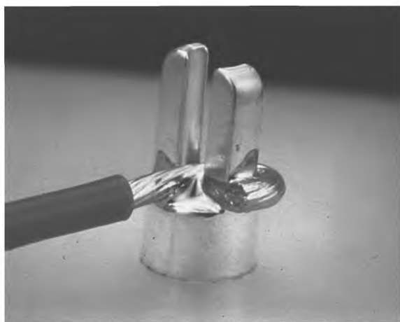
Рисунок 34 — Паяное соединение провода с контактом: допустимое состояние
