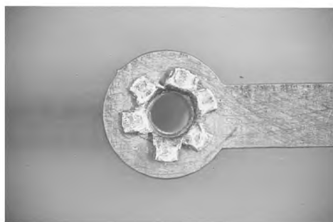
Рисунок 1 — Разрывы фланца с раструбом: виды состояний
