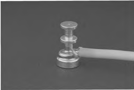
Рисунок 39 — Паяное соединение изолированного провода с контактом, небольшое освобождение от изоляции: виды состояний
