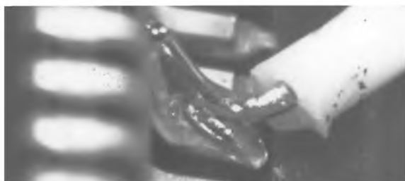
Рисунок 33 — Треснутое паяное соединение: недопустимое состояние
