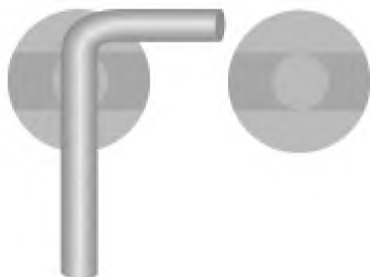
Рисунок 7 — Боковое соединение разводки, вилкообразный контакт — недопустимое состояние
