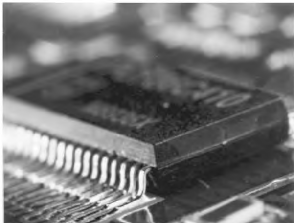
Рисунок А.1 — Галтель припоя: заданное состояние
