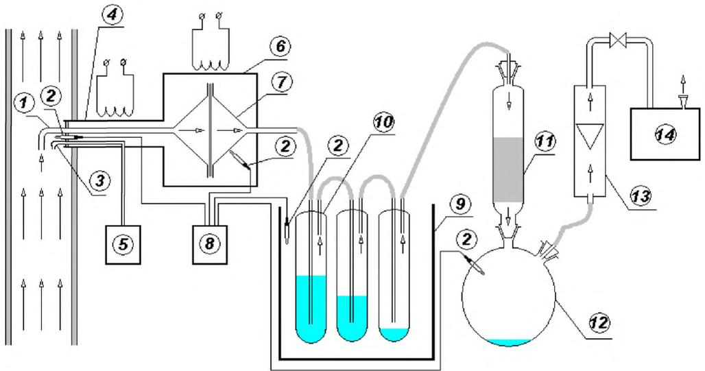
Рисунок Б1: Пробоотборное устройство
