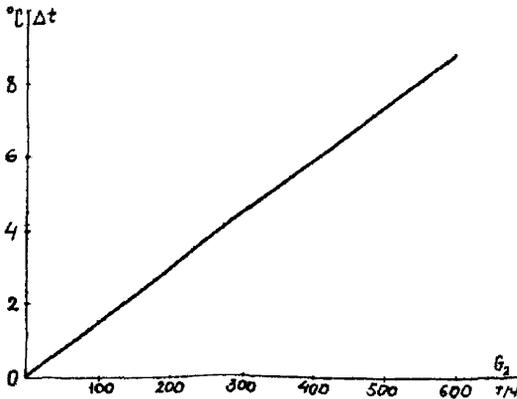
Рисунок Н.6 - Зависимость нагрева охлаждающей воды в конденсаторе 300-КЦС-1 ( $\Delta t$ ) от паровой нагрузки ( $G_2$ ) при расходе охлаждающей воды 36000  $\text{м}^3/\text{ч}$
