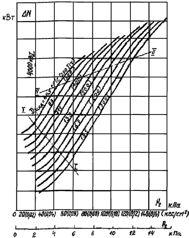
Рисунок П.3 - Поправки к мощности стурбины К-300-240 ПОАТ ХТЗ на изменение давления в конденсаторе
