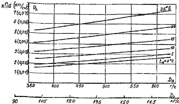
Рисунок П.2 - Давление в конденсаторе Н-15240 ПОАТ ХТЗ в зависимости от расхода пара  $D_2$  и температуры охлаждающей воды  $t_{10}$  (при номинальном расходе охлаждающей воды  $W = 34800 \text{ м}^3/\text{ч}$ )
