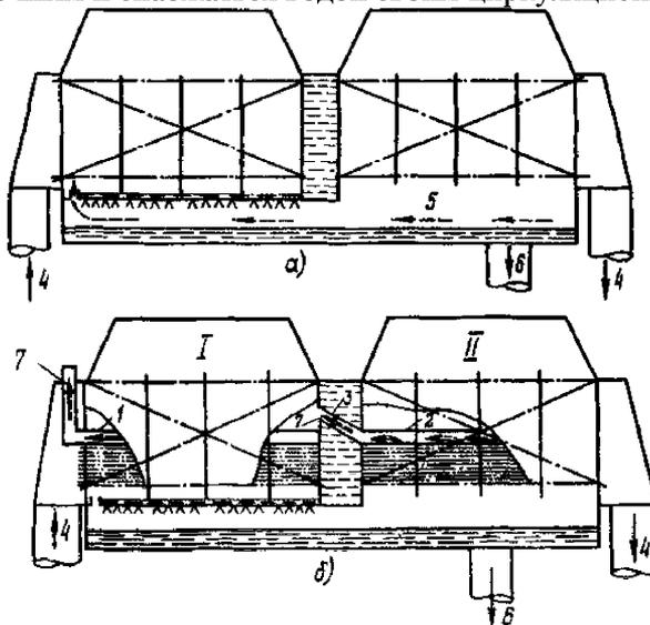
1,2 - воздушные коллекторы; 3 - перепуск паровоздушной смеси к воздухоохладителю первой секции; 4 - охлаждающая вода; 5 - пар; 6 - конденсат; 7 - паровоздушная смесь; I - первая секция по давлению; II - вторая секция
