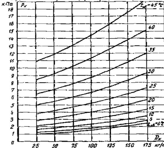
Рисунок Р.5 - Давление в конденсаторе (к примеру 6)
