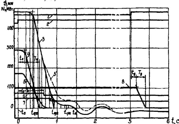
1 - напряжение соленоидов ЗУ; 2 - напряжение (ток) ЭМП; 3 - изменение электрической нагрузки ТГ; 3' - то же при отказе КОС; 4 - ход серводвигателя РКВД; 5 - ход серводвигателей РКСД; 6 и 7 - сигналы закрытия КОС ЧВД и ЧНД соответственно; 8 - ход стопорного клапана.
