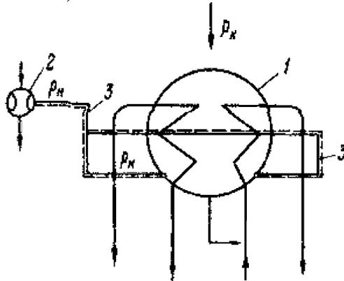
1 - конденсатор; 2- воздушный насос; 3 - коллектор паровоздушной смеси
