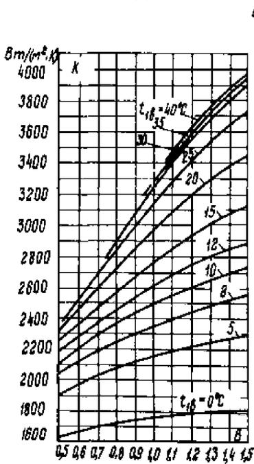
Рис. Р.1.1 - Коэффициент теплопередачи двухходового конденсатора:
