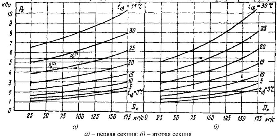
Рисунок Р.7 - Давление в секциях конденсатора (к примеру 7)
