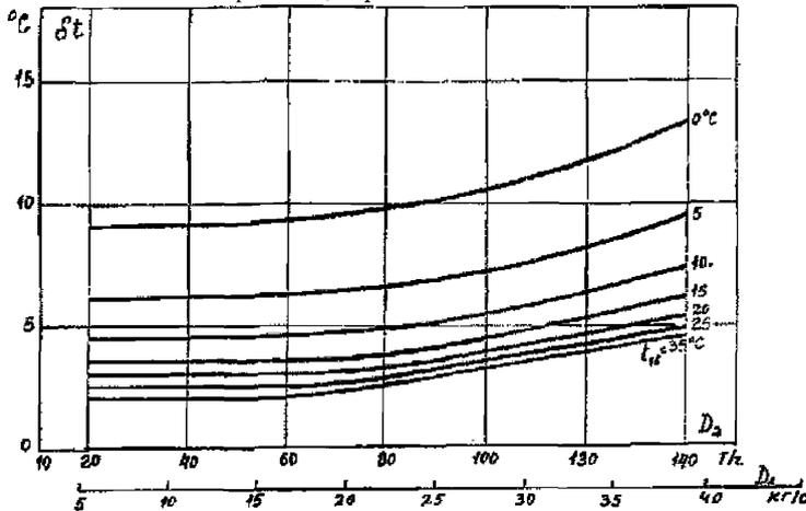
Рисунок П.4 - Температурный напор в конденсаторе К2-3000-2 ПОАТ ХТЗ в зависимости от расхода пара  $D_2$  и температуры охлаждающей воды  $t_w$  (при номинальном расходе охлаждающей воды  $W = 34800$  м<sup>3</sup>/ч)
