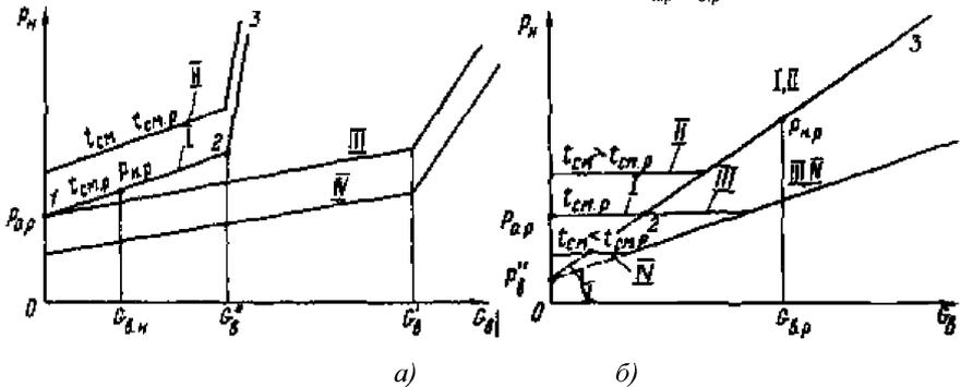
I - характеристика одного эжектора при расчетном режиме; II - то же при температуре смеси, превышающей расчетную; III - совмещенная характеристика двух эжекторов при расчетной температуре смеси; IV - то же при температуре смеси ниже расчетной; V - сухой воздух.
