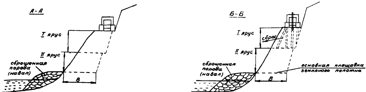
Рис. 3.13. Технологическая схема разработки полувывемок на косогорах при взрывах на сброс
