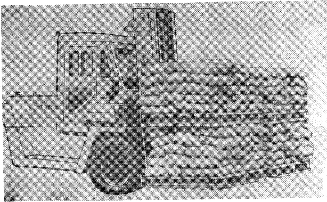
Рис. 106.16. Внутрипортовое транспортирование одновременно 4-х пакетов цемента на поддонах. Порт Николаев.
