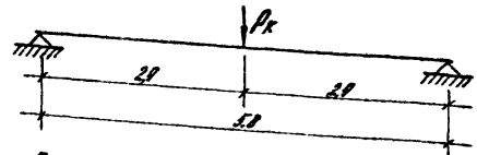
Схема замера прогиба при испытании: а) блок с напрягаемой арматурой
