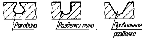
Рисунок 2 – Формы разделки под заварку несквозных дефектов
