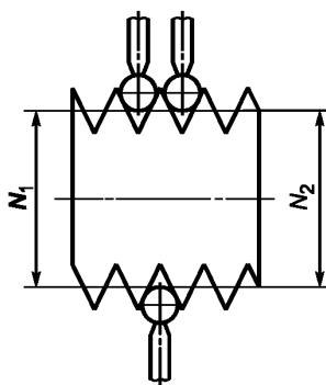
Рисунок 8 — Измерение среднего диаметра калибров-пробок на ДИП
