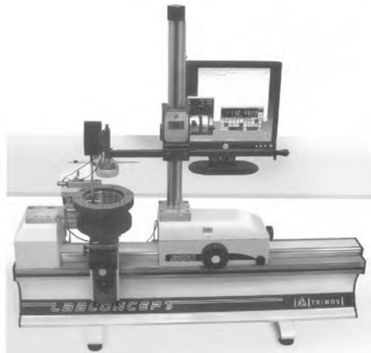
Рисунок Д.1 — Горизонтальный длиномер LabConcept 500
