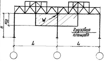
Значения нагрузок даны с учетом аэродинамического коэффициента  $C=0,8$ , размеры смежных пролетов приняты одинаковыми
