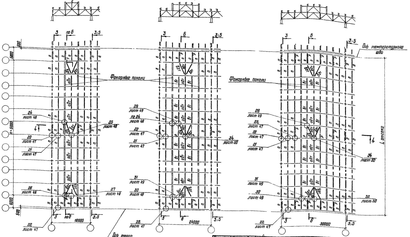
1. На схемах шаг колонн по средним рядам принят 6м. При шаге колонн по средним рядам 12м. по колоннам устанавливаются подстропильные фермы, а расположение связей принимается по данному листу.
