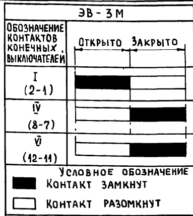
ДИАГРАММА ЗАМЫКАНИЯ КОНТАКТОВ КОНЕЧНЫЕ ВЫКЛЮЧАТЕЛИ ЭЛЕКТРОМАГНИТНОГО ПРИВОДА ИМ
