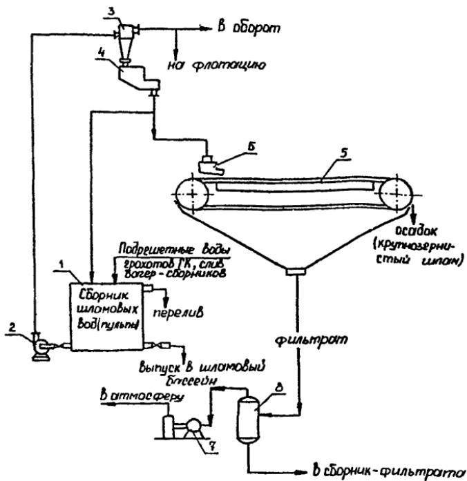
1 - сборник, 2 - насос, 3 - гидроциклон, 4 - распределительное устройство,
