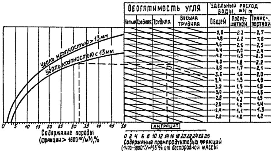
Рис. 7.12 Номограмма для определения удельного расхода воды на отсадку угля
