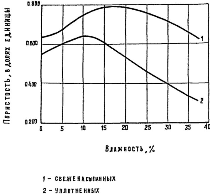
Рис. 76 Зависимость пористости отходов флотации от их влажности.
