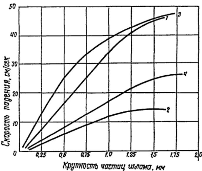
Рис. 7.8. Зависимость скорости падения частиц угольного (1,2) и антрацитового (3,4) шламов в свободных (1,3) и стесненных (2,4) условиях от их крупности.
