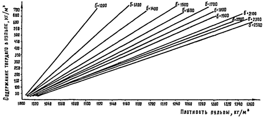
Рис.77. Зависимость плотности пульпы от содержания твердого при различной его плотности -  $\delta$  [ $\text{kg}/\text{m}^3$ ]
