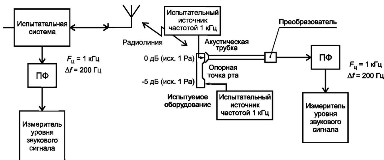
**П р и м е ч а н и е** — Испытуемое оборудование применяют при установлении опорного уровня выходного звукового сигнала на обратной линии. При установлении опорного уровня выходного звукового сигнала на прямой линии испытуемое оборудование заменяют источником звукового испытательного сигнала с частотой 1 кГц. Во время установления уровня сигнала на обратной линии микрофон должен размещаться по отношению к опорной точке рта, как при обычном применении.
