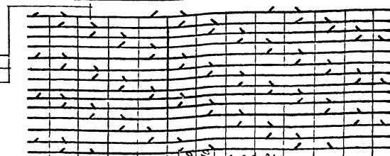
Разбивка стыков наружной кольцевой арматуры
