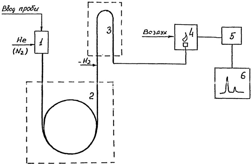
Принципиальная схема газохроматографической системы для определения оксида углерода (II):
