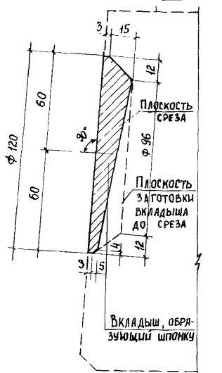
ДЕТАЛЬ ЗАГОТОВКИ ВКЛАДЫША, ОБРАЗУЮЩЕГО ШПОНКУ
