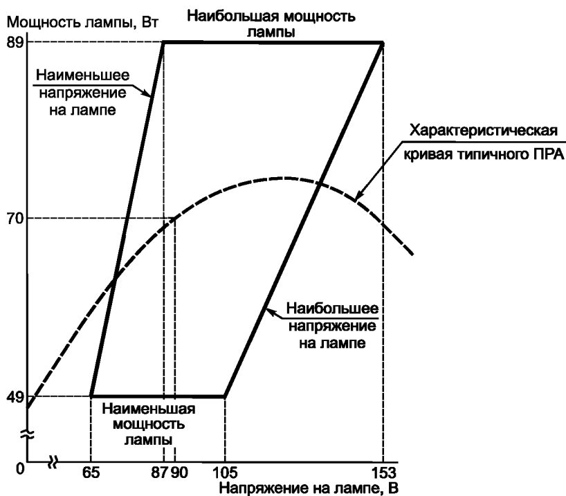
Рисунок Н.6 — Предельные рабочие характеристики ламп номинальной мощностью 70 Вт с прозрачной трубчатой, эллипсоидной прозрачной или с диффузным покрытием колбой
