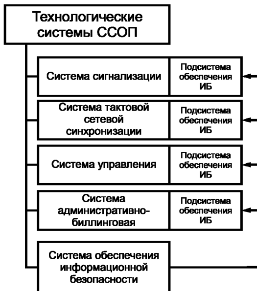
Рисунок 4 — Взаимосвязь СОИБ с технологическими системами ССОП
