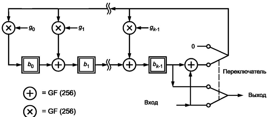
Рисунок 5 — Схема генерации кодовых слов исправления ошибки
