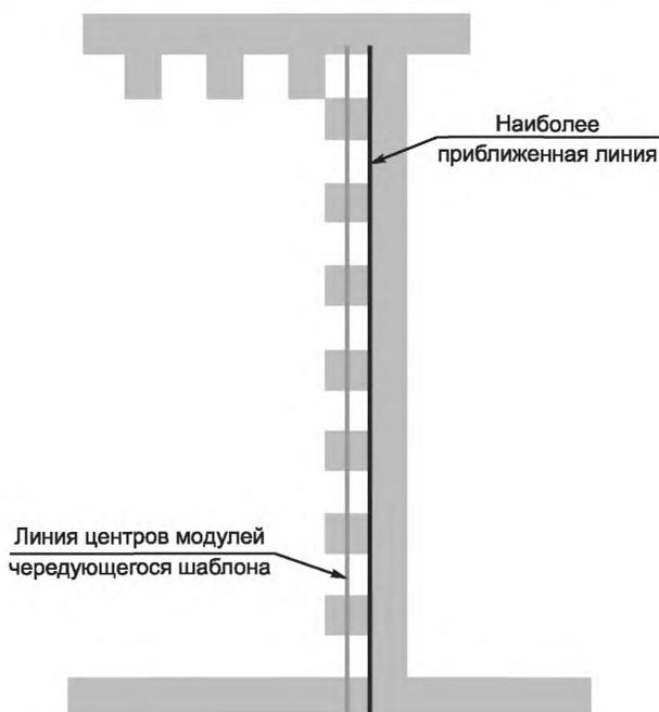
Рисунок 12 — Линия центров модулей чередующегося шаблона
