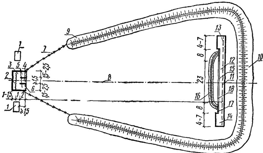
Рис. 3. План-схема тира для скоростной стрельбы по движущейся мишени «бегущий олень» (размеры, м)
