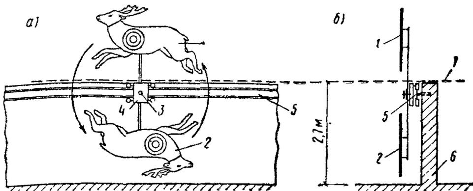
Рис. 10. Схема устройства мишенной установки «бегущий олень»:
