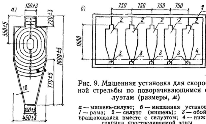
Рис. 9. Мишенная установка для скоростной стрельбы по поворачивающимся силуэтам (размеры, м)
