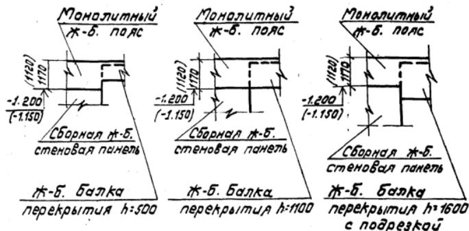
1. На узлах даны максимальные сечения главных балок перекрытия на отметке 0.000.
