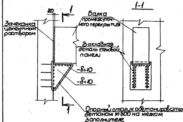
Конструкция столика для опирания балки и закладной детали в стеновой панели разрабатывается в каждом конкретном проекте.
