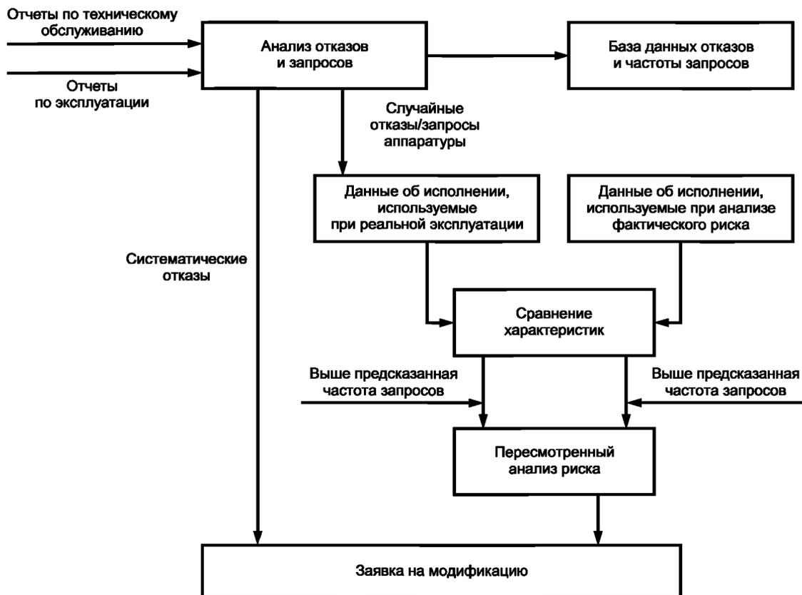
Рисунок 4 — Пример модели управления эксплуатацией и техническим обслуживанием
