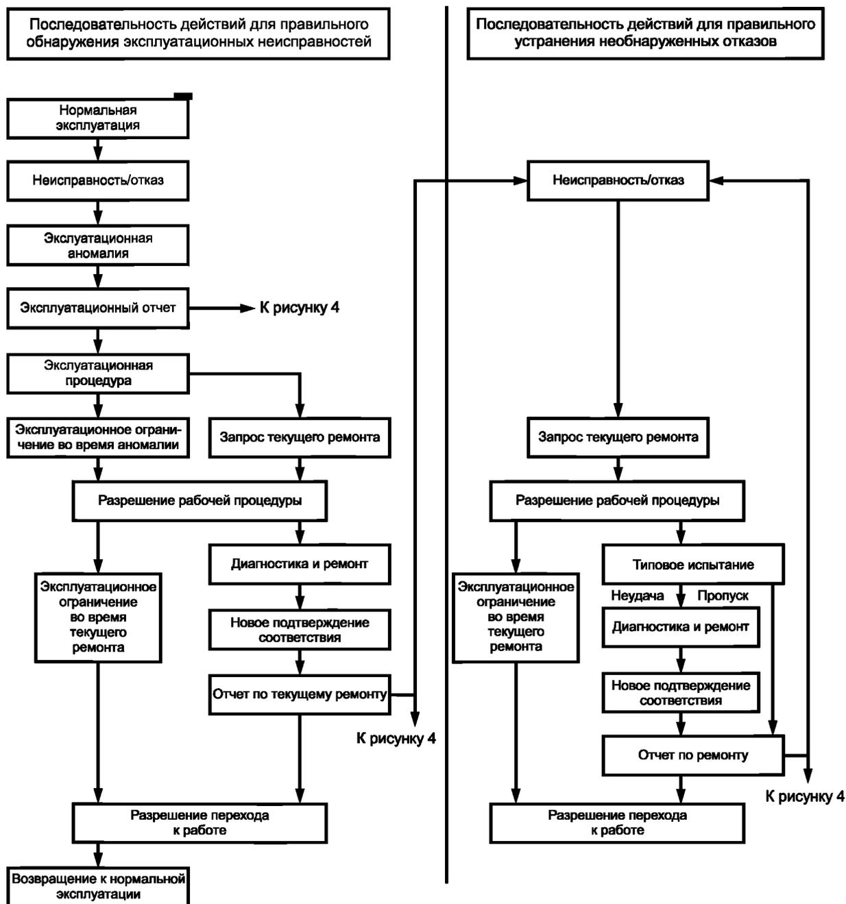
Рисунок 3 — Пример модели эксплуатации и текущего ремонта
