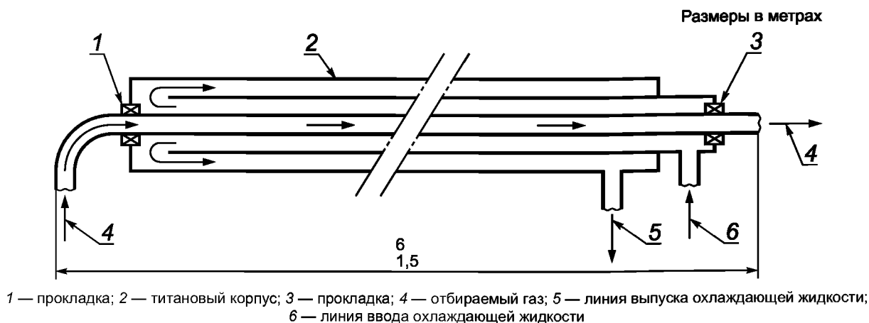
Рисунок В.8 — Пример охлаждаемого зонда
