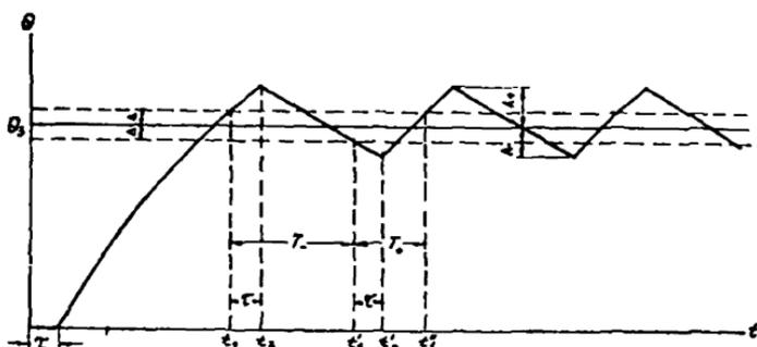
Рис. 6. График расчета процесса двухпозиционного автоматического регулирования температуры
