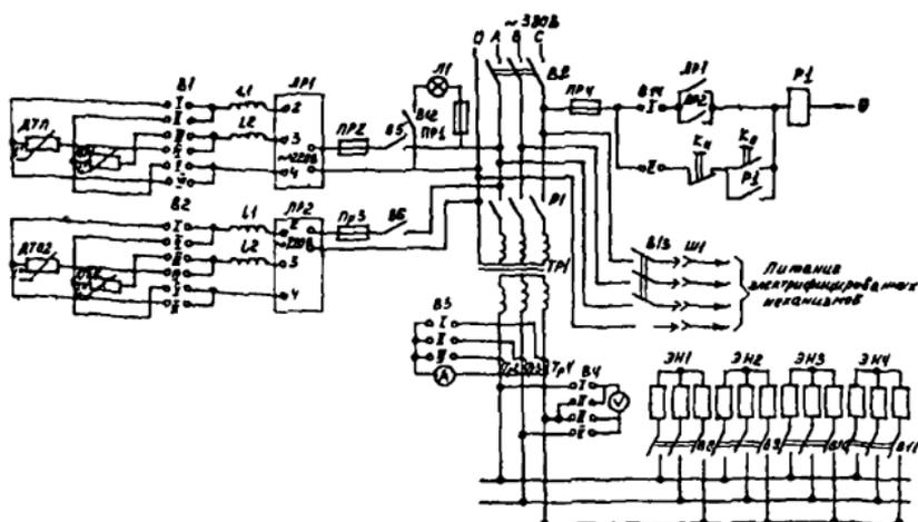
Рис. 7. Схема управления электронагревательным устройством на пониженном напряжении
