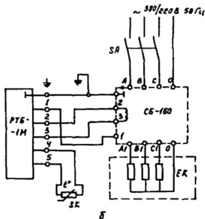
Рис. 9. Схема управления электрообогревом с применением тиристорных элементов:
