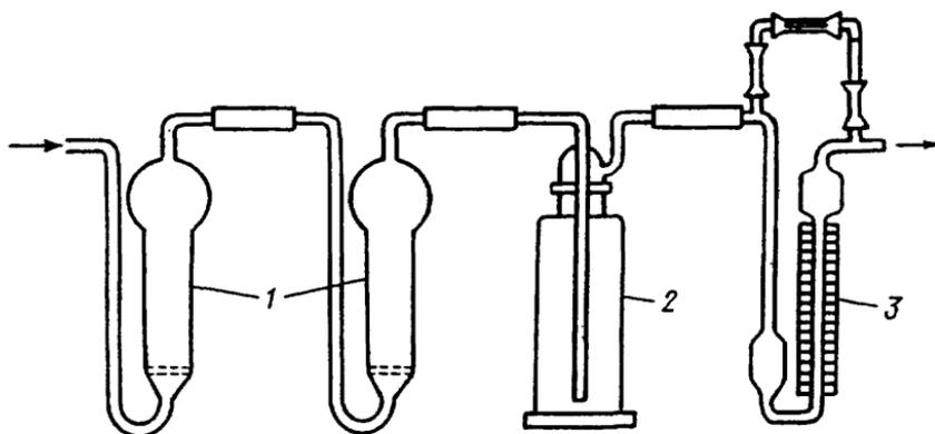
Рисунок А.1 – Схема установки для отбора газовых выбросов
