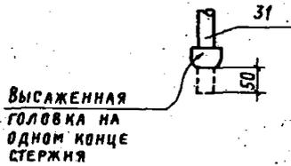
Высаженная головка на одном конце стержня
