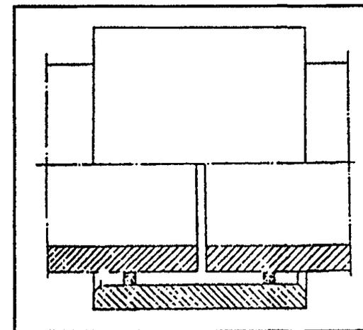
Величину зазора торцами соединяемых труб следует принимать для труб диаметром:
