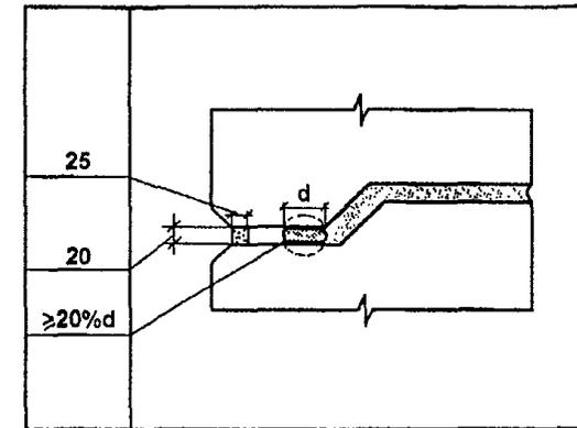
Соединение уплотняющих прокладок по длине должно быть «на ус», место соединения — на расстоянии не менее 0,3 м от пересечения вертикального и горизонтального стыка.
