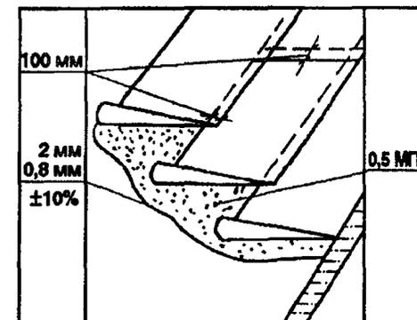
Полотнища изоляции должны укладываться внахлестку на 100 мм.
