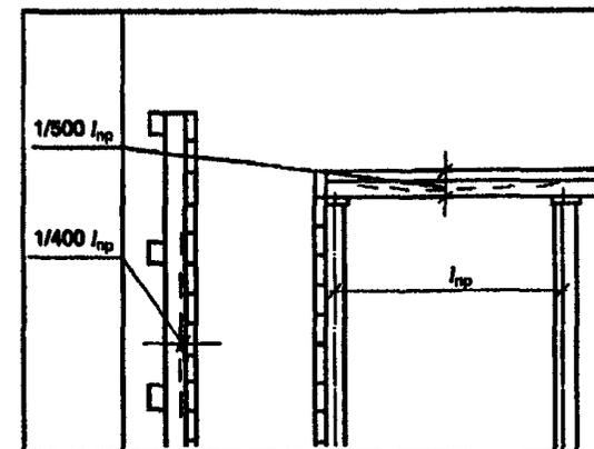
Прогиб формообразующей поверхности и несущих элементов опалубки под действием воспринимаемых нагрузок при пролете  $l$  не должен превышать:
