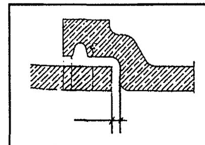
Величину зазора между упорной поверхностью раструба и торцом соединительной трубы (независимо от материала заделки стыка) следует принимать для труб диаметром:
