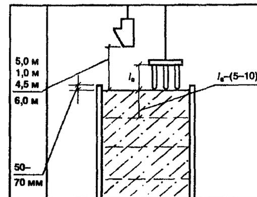
Высота свободного сбрасывания бетонной смеси в опалубку конструкции, м, не более:
