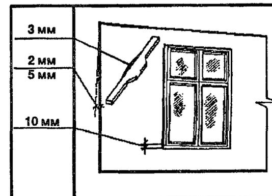
Приемку малярных работ необходимо производить после высыхания водных красок. Поверхности после высыхания водных составов должны быть однотонными, местные исправления, выделяющиеся на общем фоне (кроме простой окраски), не должны быть заметны на расстоянии 3 м от поверхности.
