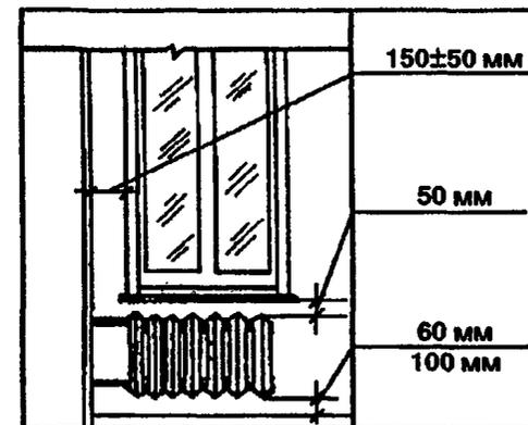
Уклоны подводов к радиаторам — от 5 до 10 мм на длину подводки в сторону движения теплоносителя.
