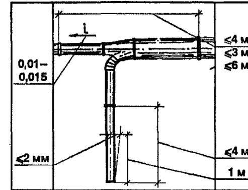
Участки воздуховодов следует монтировать с уклоном 0,01—0,015 в сторону дренарующих устройств.
