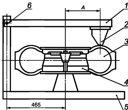
1 — подвижный рычаг; 2 — специальный упор; 3 — шина; 4 — обод; 5 — неподвижная плита (основание);
