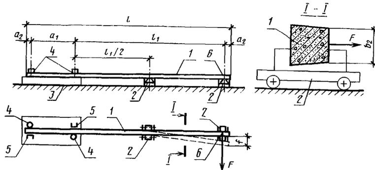
1—испытываемая стойка; 2—подвижная опора; 3—бетонная площадка; 4—упор; 5—фиксатор; 6—место приложения нагрузки
