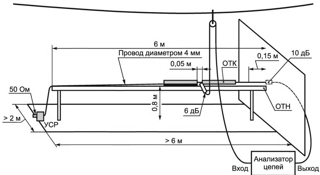
УСП — устройство связи — развязки типа М; ОТК — опорная точка поглощающих клещей; ОТН — опорная точка направляющих
