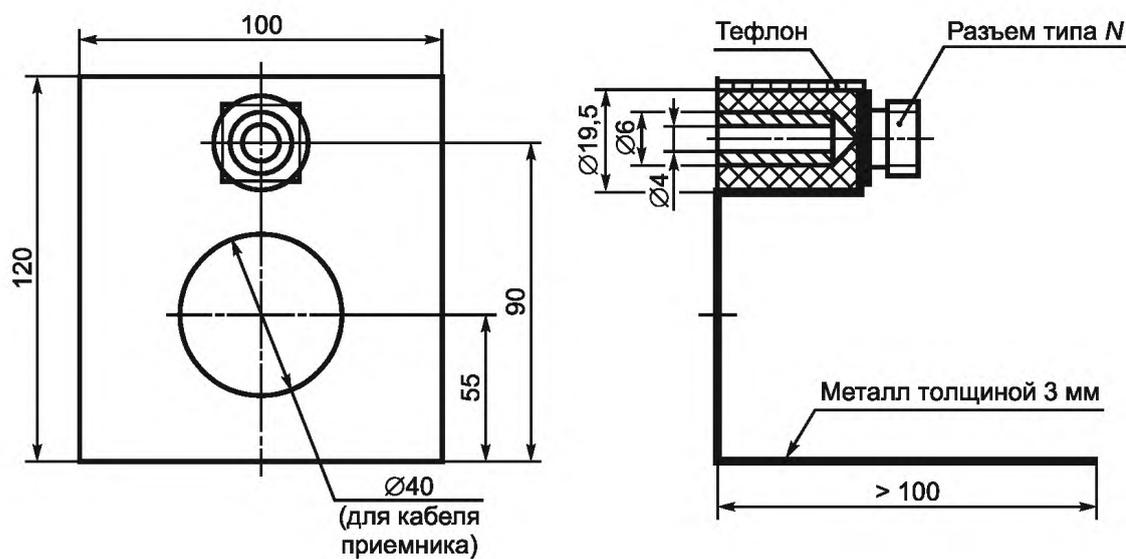
Примечание — Нижняя часть должна быть электрически соединена с пластиной заземления.
