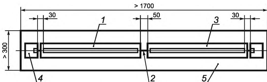
1 — поглощающие клещи; 2 — провод диаметром 4 мм; 3 — ВПУ; 4 — электрическая связь с пластиной заземления; 5 — металлическая пластина заземления
