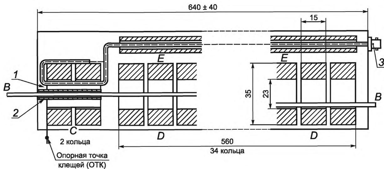
*B* — испытуемый провод; *C* — трансформатор тока; *D* — поглощающая секция; *E* — поглощающая секция на кабеле от трансформатора; 1 — металлический цилиндр из двух половин; 2 — трубка для центровки провода *B*; 3 — коаксиальный разъем (для аттенюатора с затуханием 6 дБ)
