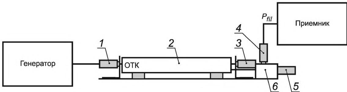
$P_{fil}$  — мощность, измеряемая приемником; 1, 4 — аттенюатор с затуханием 10 дБ; 2 — испытуемые клещи; 3, 5 — нагрузка 50 Ом; 6 — УСП
