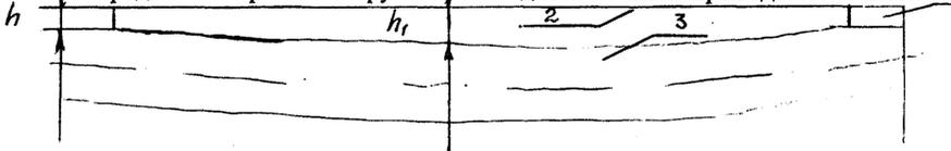
Где: 1- установочная призма, 2-струна (леска), 3-образующая трубы
