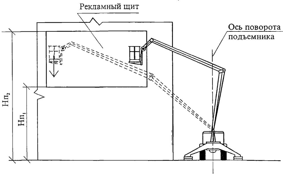
Рисунок 8 – Вариант установки подъемника при монтаже рекламного щита, расположенного на стене существующего здания
