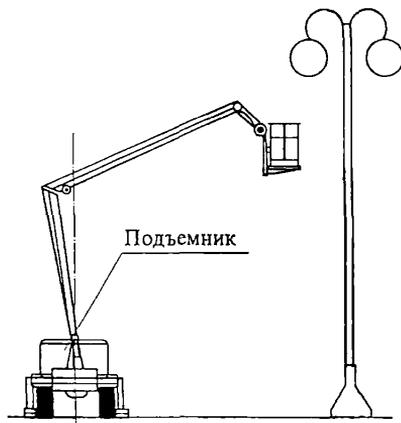
Рисунок 4 – Схема производства работ по наружному освещению
