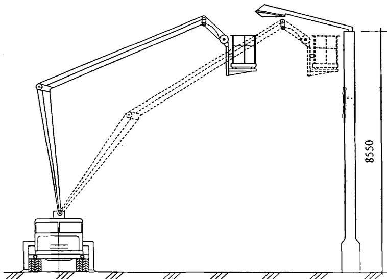
Рисунок 3 – Схема производства работ с использованием автомобильного подъемника АГП-17.00
