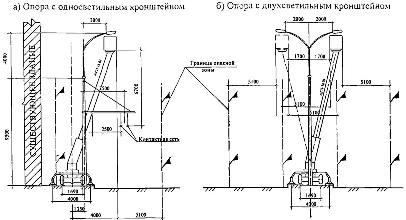
Рисунок 5 – Схема установки подъемника АГП-18.04 при монтаже, демонтаже и обслуживании опор освещения
