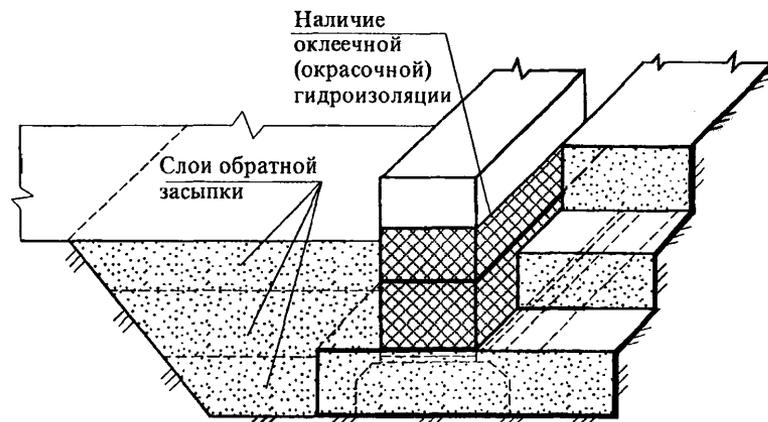
Средняя по проверяемому участку плотность сухого грунта обратных засыпок не ниже проектной, а при отсутствии в проекте указаний должна быть не ниже плотности, соответствующей контрольным значениям коэффициента уплотнения, приведенным в таблице 8 СНиП 3.02.01-87 «Земляные сооружения, основания и фундаменты». Допускаются значения плотности сухого грунта ниже проектных на  $0,06 \text{ г/см}^3$  в отдельных определениях, но не более чем в 20% определений.
