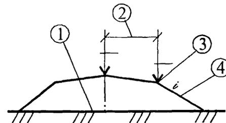
2 Сужение земляного полотна (уменьшение расстояния от оси до бровки) не допускается;
