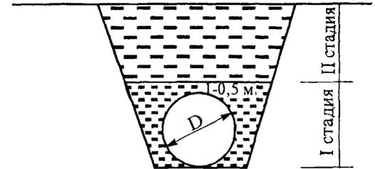
Для труб асбестоцементных, пластмассовых, керамических, железобетонных
