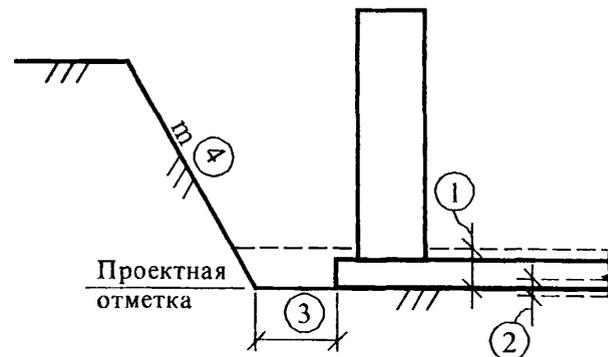
Таблица – Крутизна откосов котлованов в зависимости от видов грунтов и глубины выемки (СНиП 12-04-2002)
